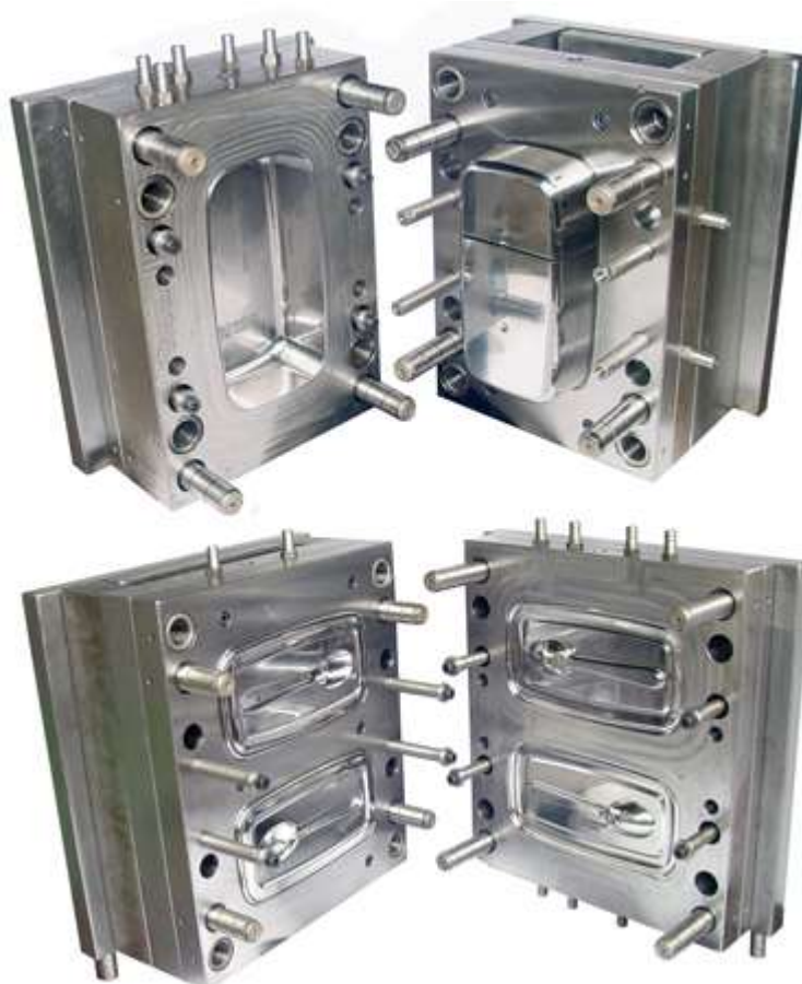
Obr. 14 Príklad formy na 1 výrobok (hore) a dvojnásobnej formy (dole) [14].
