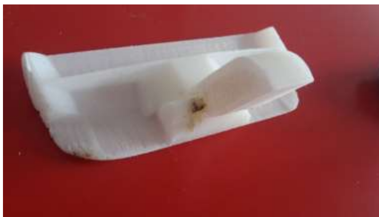
Obr. 23 Prvý vytlačený prototyp s viditeľnými defektami.
