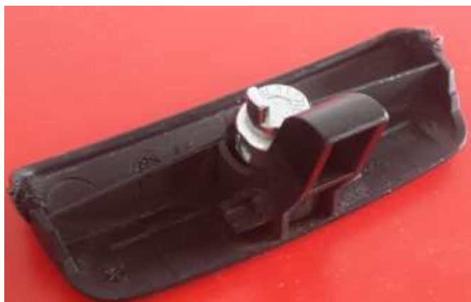
Obr. 2 Detail odlomeného uloženia.
