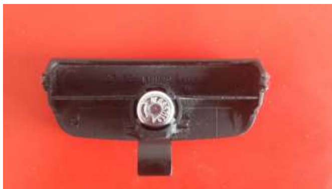
Obr. 1 Kľučka s odlomenými uloženiami.
