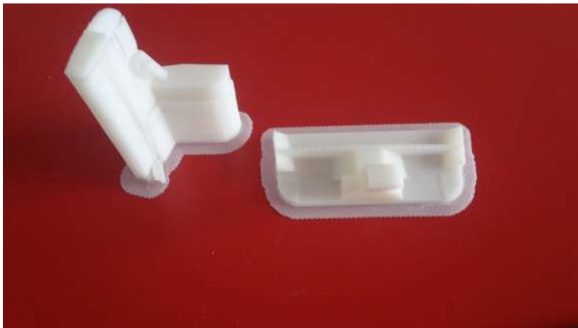
Obr. 24 Finálny model vytlačený vo vertikálnej aj vodorovnej polohe s podporami.
