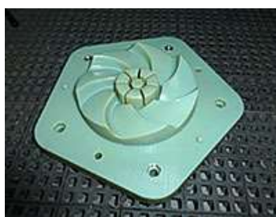
Obr. 15 Jadro formy vyrobenej technológiou PolyJet z materiálu Digital ABS [15].
