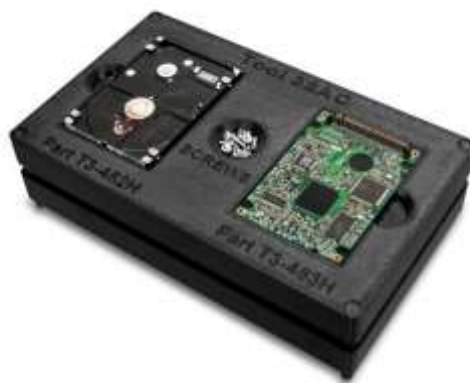
Obr. 5 Držiak pevného disku vyrobený z ABS ESD7. [28]
