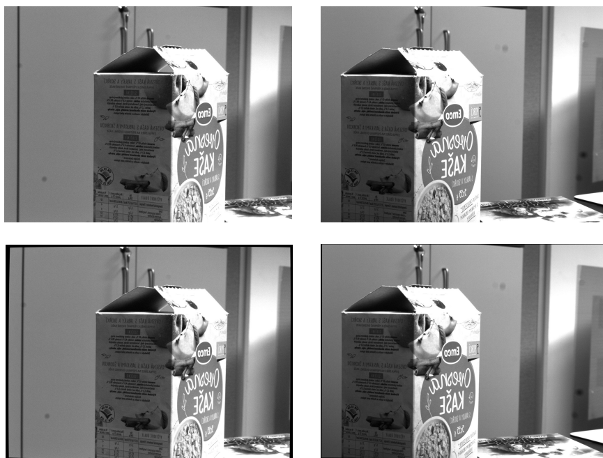
Obrázek 6.1: Porovnání snímků před a po odstranění zkreslení a po provedení rektifikace. Horní pár snímků jsou původní snímky. Spodní pár snímků jsou snímky, z kterých bylo odstraněno zkreslení a byla na nich provedena rektifikace.
