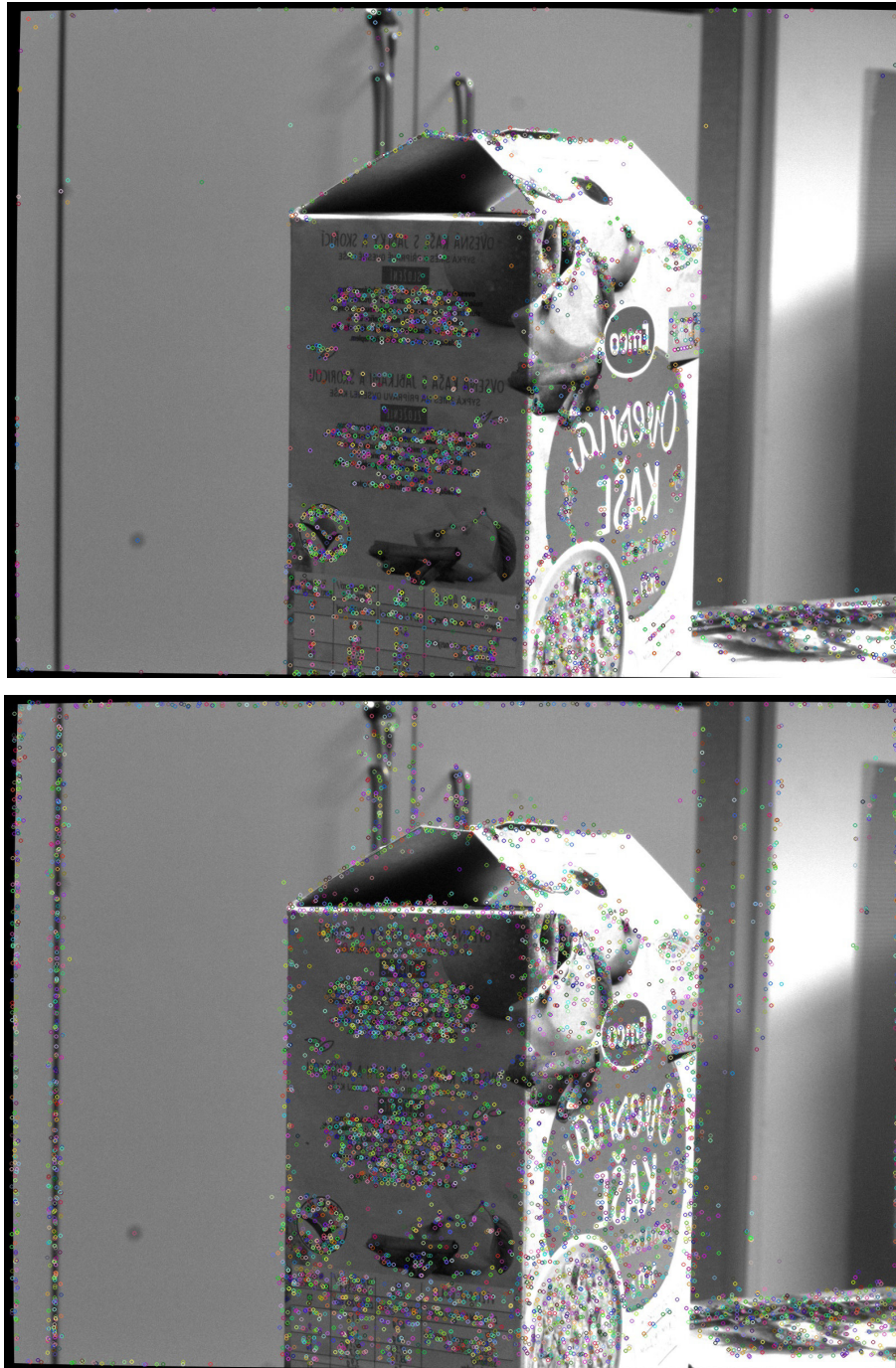
Obrázek 6.4: Horní obrázek znázorňuje nalezené klíčové body pomocí metody SIFT a spodní pomocí metody SURF.
