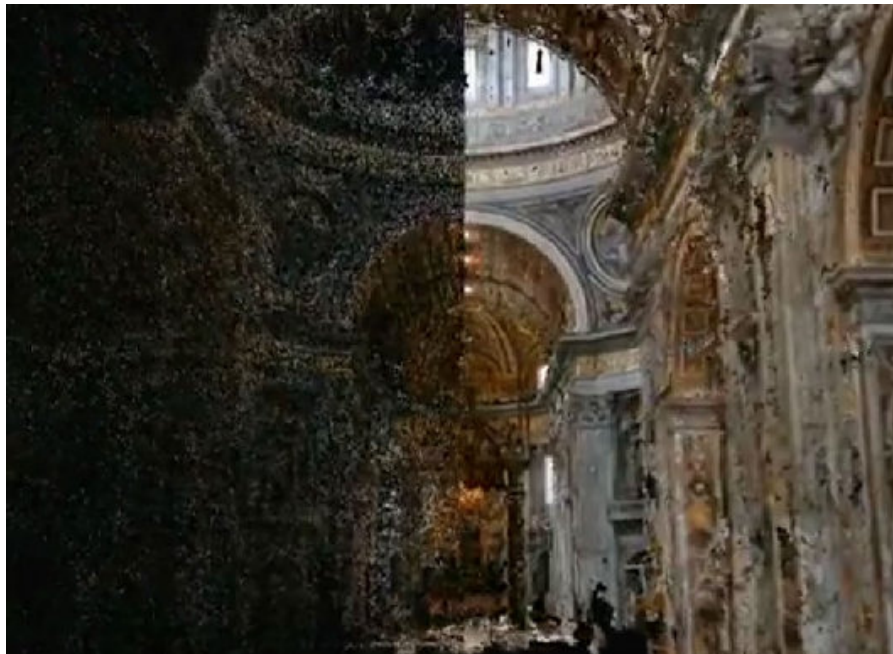
Obrázek 2.1: Na levé části obrázku je výsledek sparse rekonstrukce a na pravé straně je výsledek dense rekonstrukce rekostrukce. [19]
