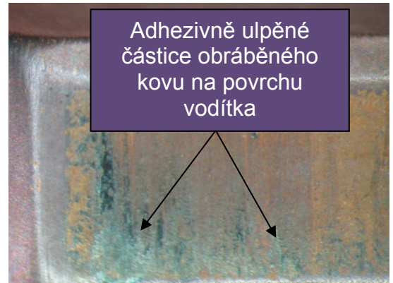
Obr. 4.13 Geometrie vodička opotřebované vystružovací hlavice MT3
