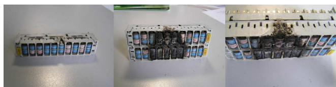
Obr. č. 13: Příklad destrukce jisticích prvků určených pro provoz v PS [3]
