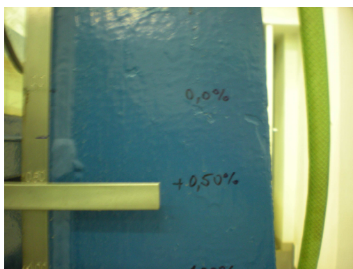
Obrázek 5.2: Možnost nastavení sklonu žlabu
