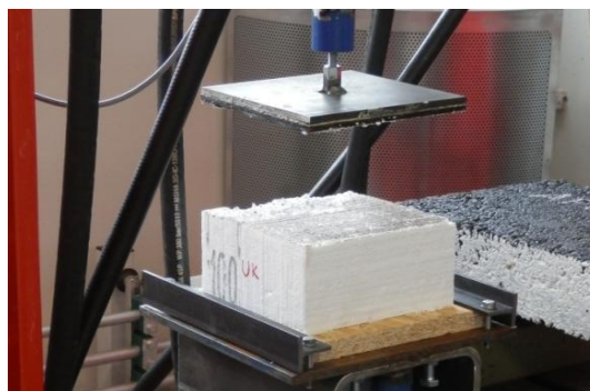
Obr. 31: Fixace zkušebního tělesa mezi stacionární rám a lis
