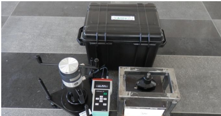
Obr. 33: Odtrhoměrné zařízení k vykonání zkoušky, zkušební těleso s ocelovou sponou a ocelový rám
