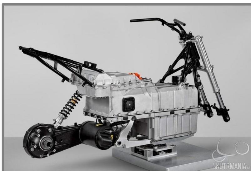
Obr. 22 Pevně zabudované baterie u skútru BMW C evolution (9)
