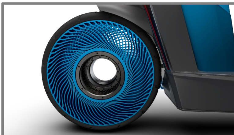
Obr. 51 Detail na zadní kolo s prstencovým elektromotorem
