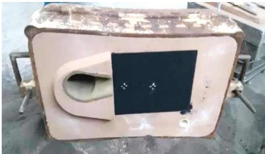
Obr. 14 Fotografie formy s 40 mm vrstvou chromitového písku
