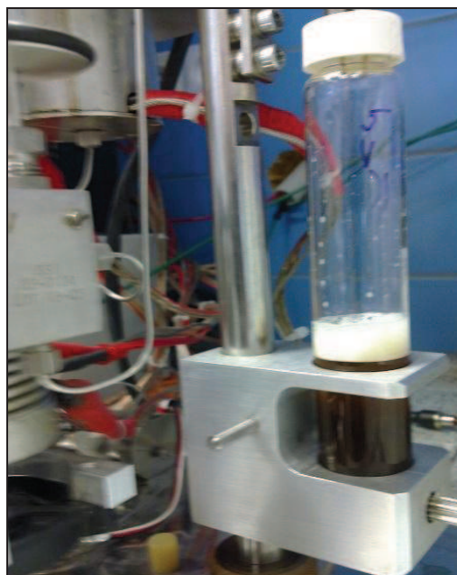
Obr. 18 Probíhající PHWE extrakce
