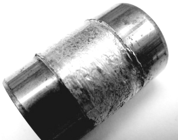
Obr. 1b) Adhezivní opotřebení pístního čepu [2]
