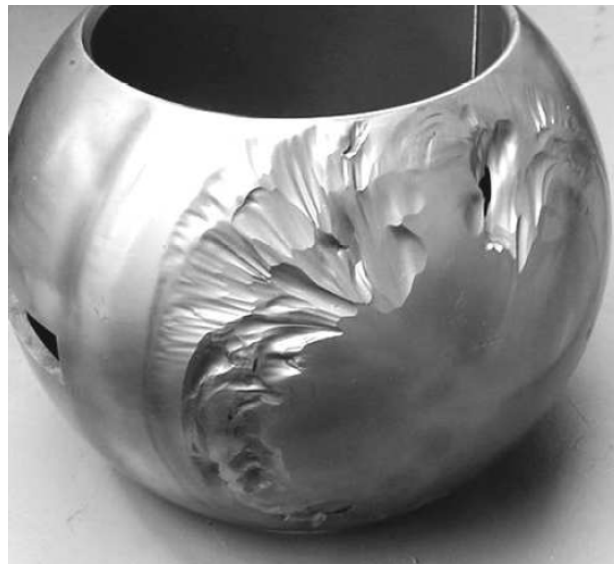
Obr. 6b) Erozivní opotřebení koule uzavěru [5]
