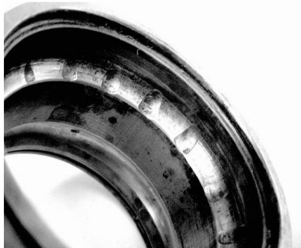
Obr. 5b) Vibrační opotřebení valivého ložiska [5]
