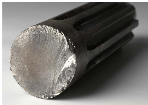
Obr. 3b) Únavový lom spojkové hřídele
