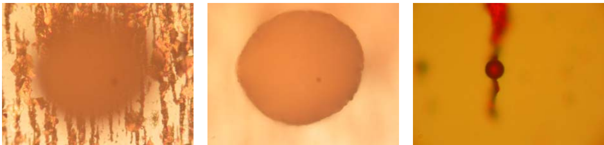
Obr. 8: Únavové částice typického kulovitého tvaru (zvětšeno 400x)
