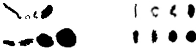
Obr. 48a) Originální obrazy částic před normalizací Obr. 48b) Obrazy částic po normalizaci, s rotací
