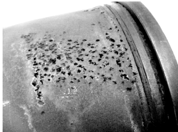
Obr. 4b) Kavitační opotřebení pouzdra válce spalovacího motoru [5]
