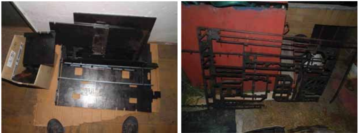
Obr. 21 – Vypálené díly a zbytky ocelové desky
