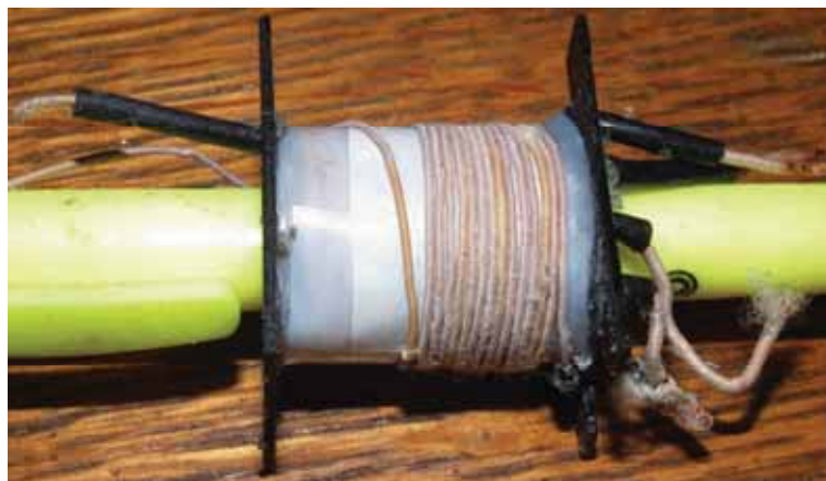
Obr. 56 – Druhá polovina primárního vinutí, následuje silikonová výplň, 4 vrstvy PTFE folie a zafixování lepící páskou.
