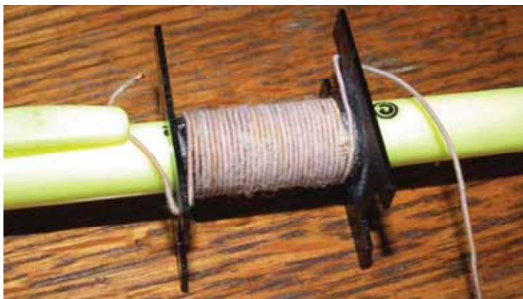
Obr. 53 – První polovina primárního vinutí, následuje silikonová výplň a 4 vrstvy PTFE folie
