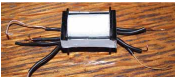
Obr. 50 – Dokončený transformátor pro standby zdroj. Jádru má vzduchovou mezeru 0,5mm rozdělenou mezi střední a krajní sloupky jádra.
