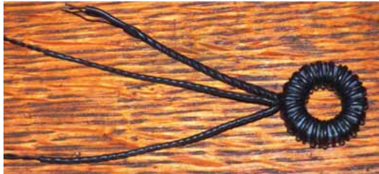
Obr. 51 – Vinutí GDT transformátoru
