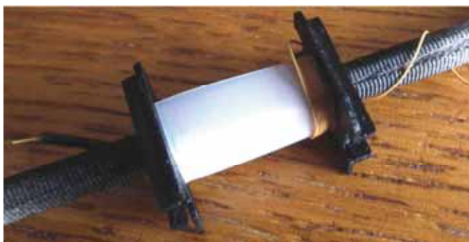
Obr. 46 – První vrstva primárního vinutí a izolace ze 2 vrstev PTFE folie
