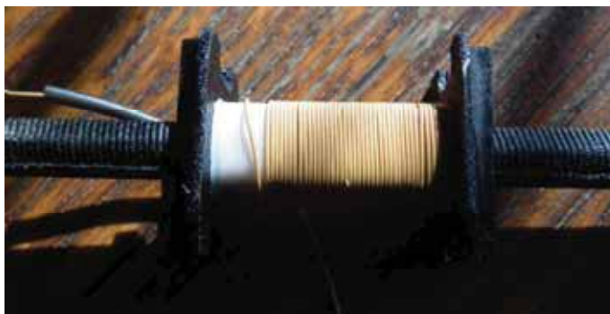
Obr. 47 – Dokončení primárního vinutí. Následují 4 vrstvy PTFE folie
