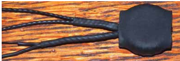
Obr. 52 – GDT transformátor ve smršťovací bužírce
