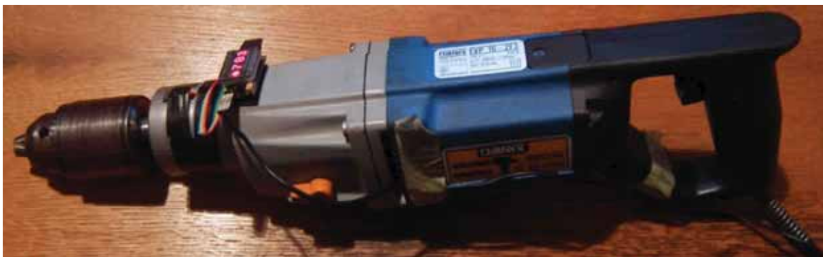
Obr. 23 – Nainstalovaný přípravek pro kontrolu kolmosti
