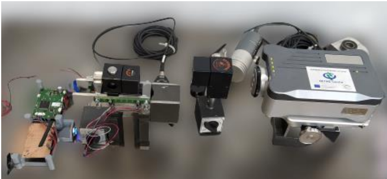
Obrázok 69- meranie polohovania testovacej platformy interferometrom.
