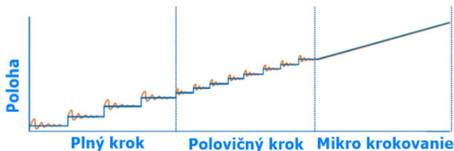
Obrázok 43- typy prevádzky motory s vplyvom na polohu natočenia [33]
