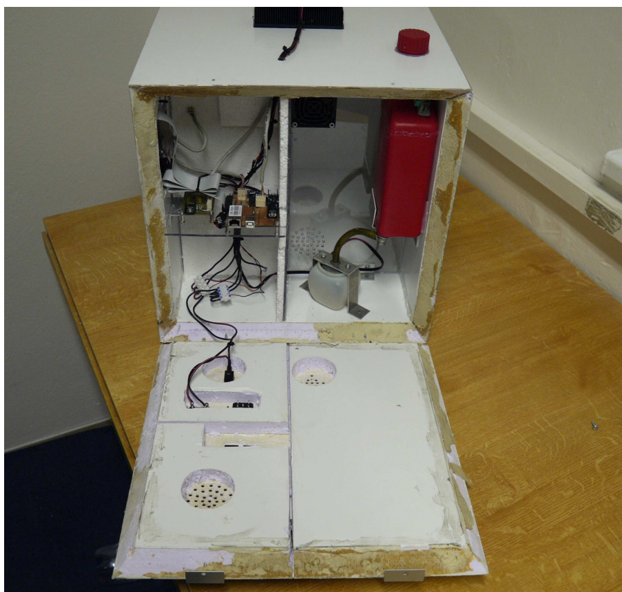
Obr. 11.30: Fotka vyrobeného inkubátoru (otvorený bočný kryt)
