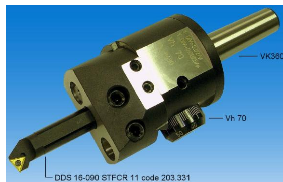
Obr. 2.8 Upnutí vnitřního nože do vyvrtávací hlavy Narex Vh-70 7
