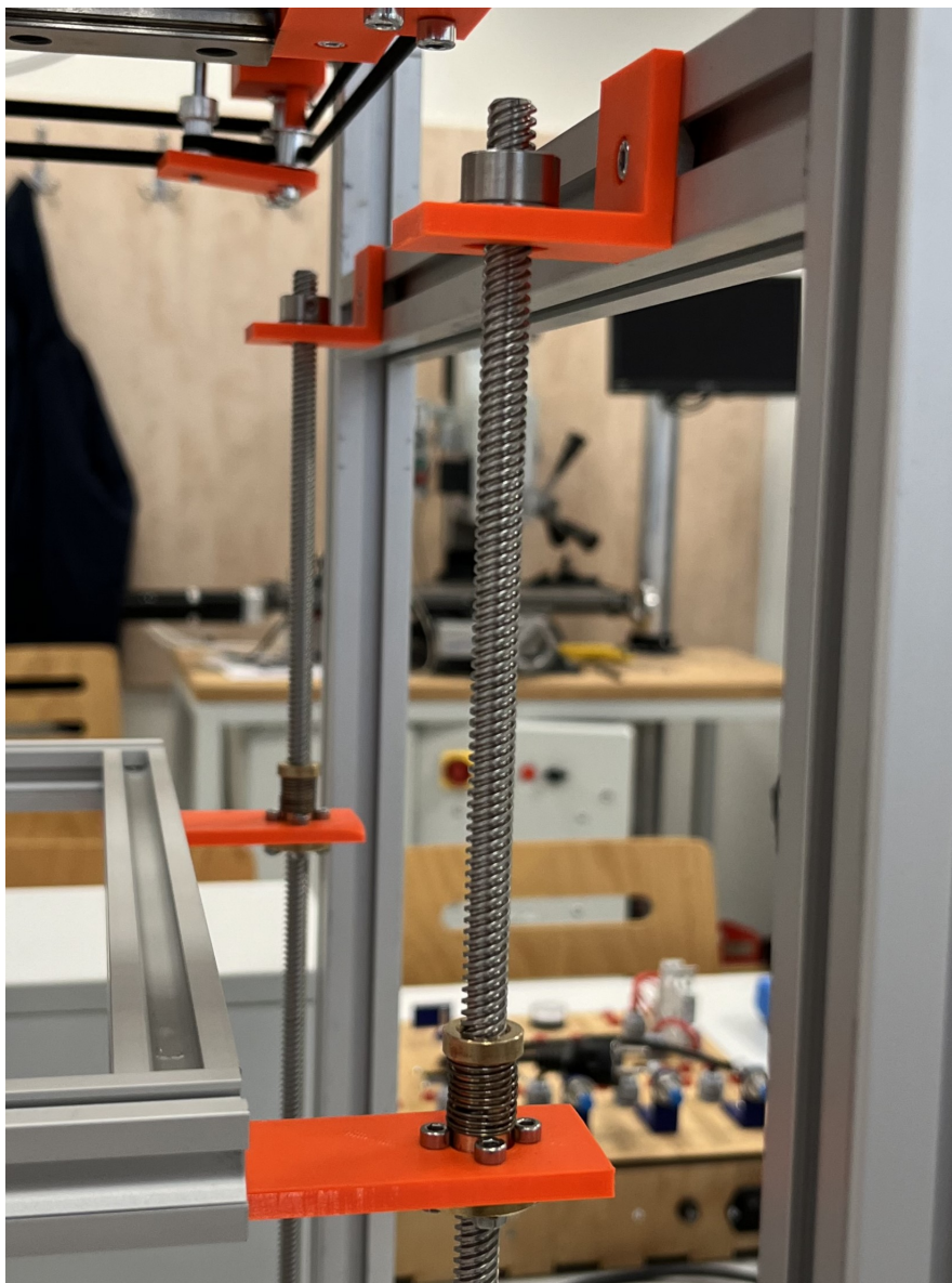
Obr. 5.4: Uchycení rámu tiskové plochy ke šroubům
