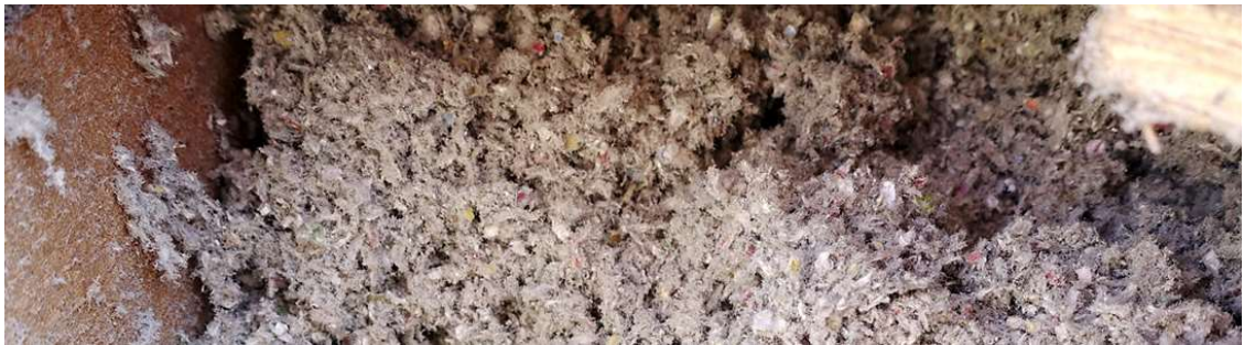
Obrázek 16: Celulózová vlákna používaná pro foukané izolace
