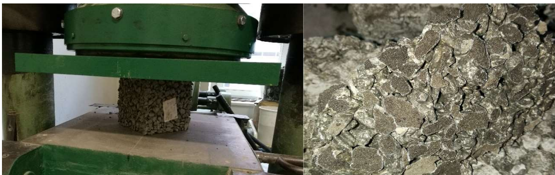
Obrázek 18: Stanovení pevnosti v tlaku a porušení zrn po provedení zkoušky
