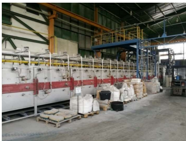
Obrázek 6: Tunelová pec pro výrobu pěnového skla
