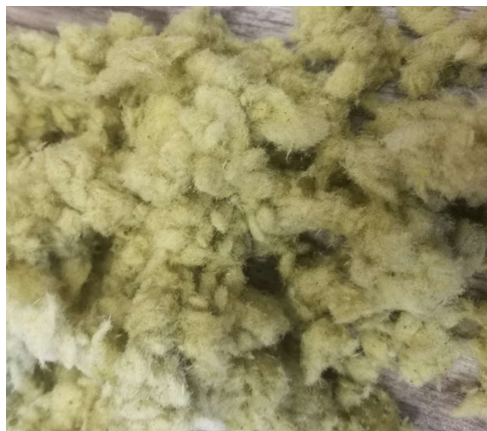
Obrázek 15: Vlákna z čedičové (kamenné) vlny
