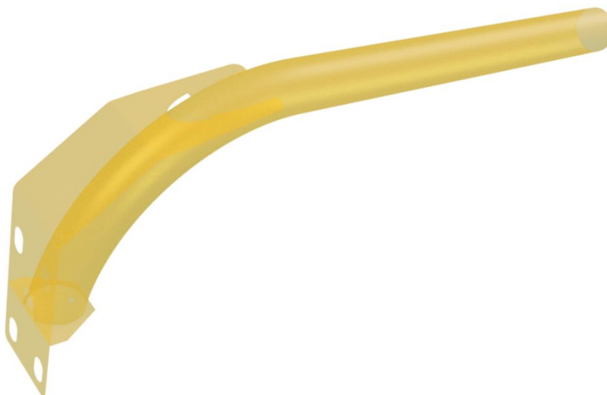
Obrázek 27: Model geometrie tvořený středními plochami
