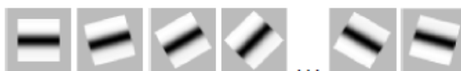
Obr. 5.1: Příklady masky rotující v rozmezí 0^\circ - 165^\circ s krokem 15^\circ (převzato z [23]).
