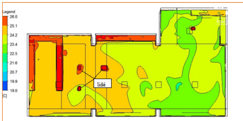
Obrázek 82. Teplota vzduchu – 1,7 m nad podlahou.
