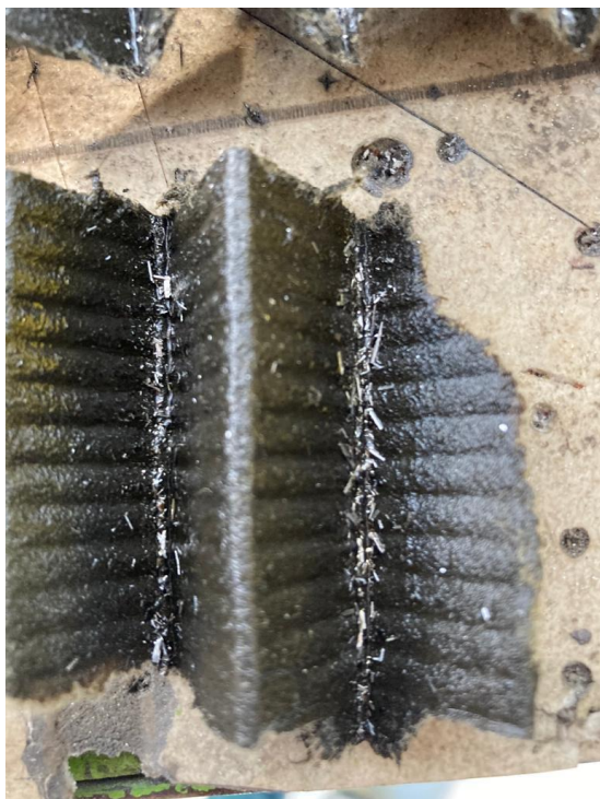
Obrázek 3.2 Část olejového filtru se šponami z motoru
