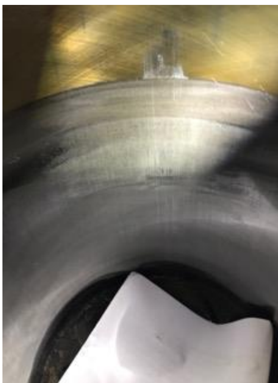
Obrázek 3.4 Detail poškozeného válce
