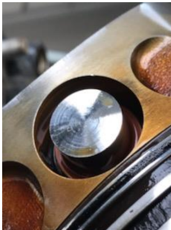
Obrázek 3.3 Pístní čep, který odíral válec
