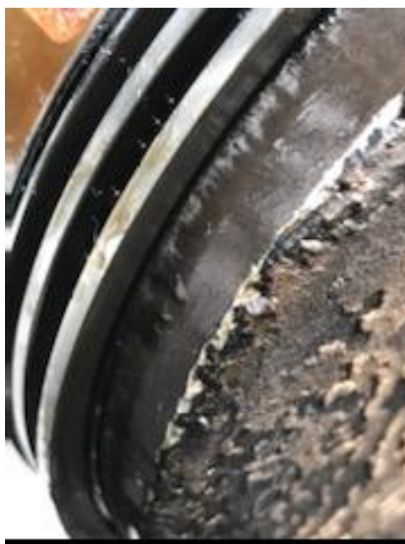
Obrázek 3.3 Pístní čep, který odíral válec
