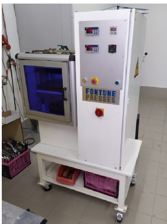
Obr. 16 Hydraulický lis Fontijne Press LabEcon 300 použitý pro výrobu škrobových fólií
