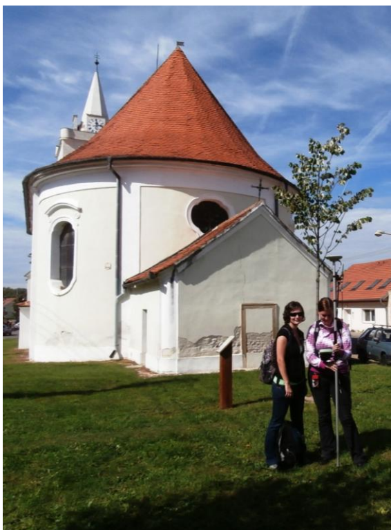
Obr. 4.1: Zaměřování bodu 4003 metodou RTK technologií GNSS
