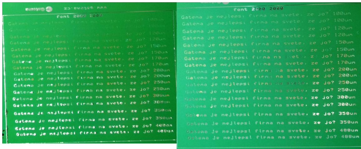
Obrázek 47 DPS , font H 2000 2000, po projetí 2x vývojkou, HAL 1/3 s, po projetí 1x vývojkou, HAL 2/5 s
