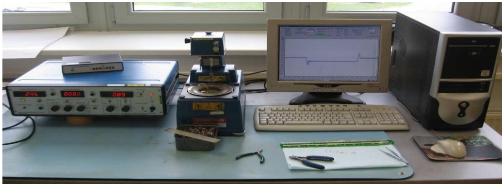
Obrázek 1 Zařízení pro měření smáčení metodou smáčecích vah [9]
