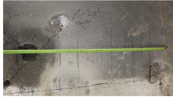
Obrázek 50: Foto zaměřování polohy sondy SVT2
