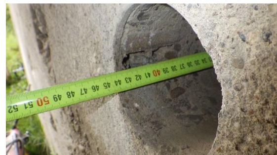
Obrázek 2: Detailní foto měření hloubky vývrtu VOP1
