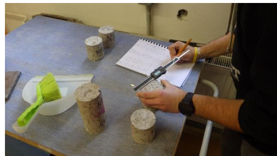
Obrázek 39: Měření a zaznamenávání rozměrů jednotlivých zkušebních těles
