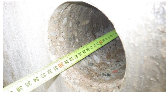
Obrázek 12: Detailní foto měření hloubky vývrtu VKP1
