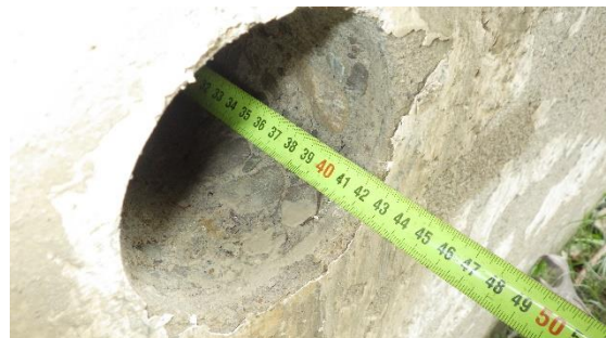
Obrázek 8: Detailní foto měření hloubky vývrtu VOP2
