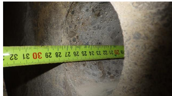
Obrázek 26: Detailní foto měření hloubky vývrtu VN2
