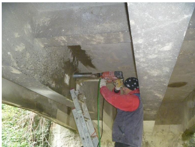
Obrázek 37: Odebírání jádrového vývrtu z trámového nosníku číslo 2
