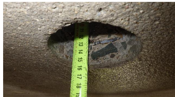
Obrázek 30: Detailní foto měření hloubky vývrtu VD1
