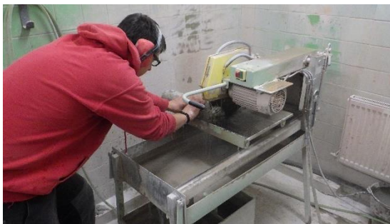
Obrázek 38: Řezání jádrových vývrtů na zkušební tělesa pomocí okružní pily
