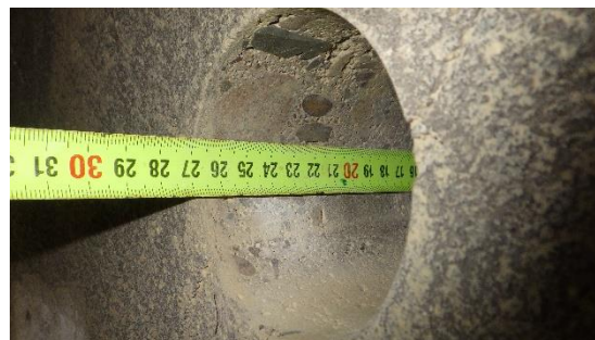
Obrázek 20: Detailní foto měření hloubky vývrtu VN1
