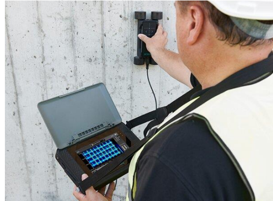
Obrázek 11: Lokalizování výztuže pomocí přístroje Profometer PM-630 [21]
