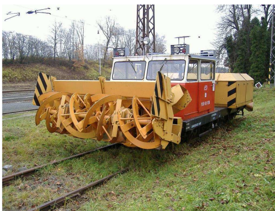
Obr. 3.13 Koľajová snežná fréza KSF 70, prevzaté z [15]
