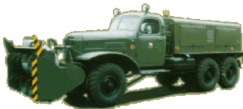
Obr. 3.9 Automobilová snežná fréza D-470, prevzaté z [14]
