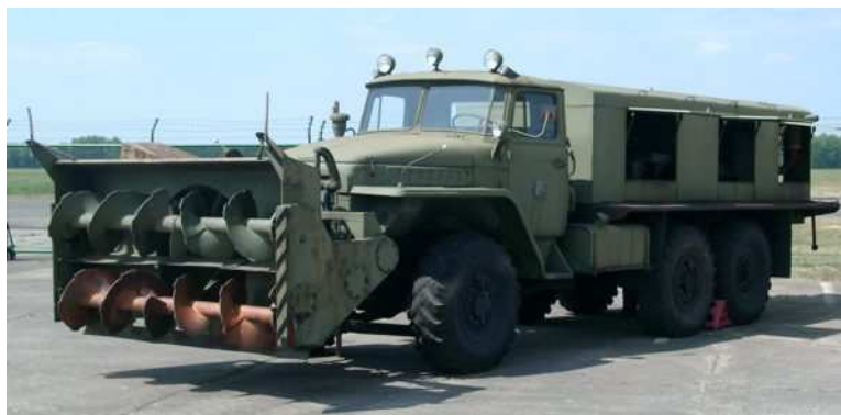
Obr. 3.10 Snežná fréza SOV - D-902, prevzaté z [16]
