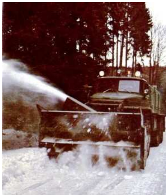
Obr. 3.11 Snežná fréza SOV - D-902 pri práci
