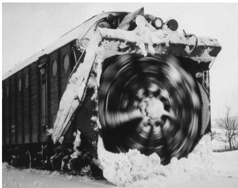
Obr. 3.5 Snehová fréza Henschel v činnosti, prevzaté z [10]
