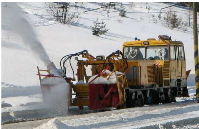
Obr. 3.15 Koľajová snežná fréza SFB 3000 pri práci, prevzaté z [18]
