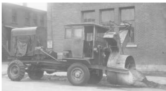
Obr. 3.2 Cestný prototyp snehovej frézy, prevzaté z [8]
