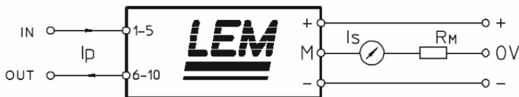
Obr. 7.5 – Způsob připojování čidla proudu LEM, převzato z web4.LEM.com
