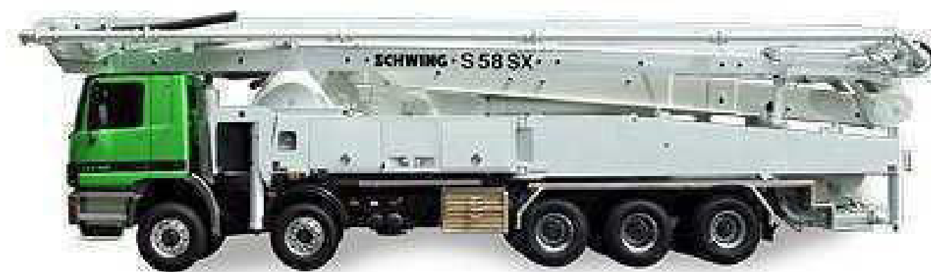
Obr. 54- Autočerpadlo SCHWING S 58 SX
