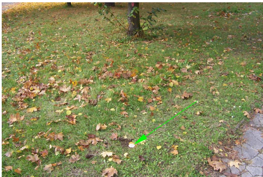
Obr. č. 17 – Stabilizace PPBP – plastovým znakem
