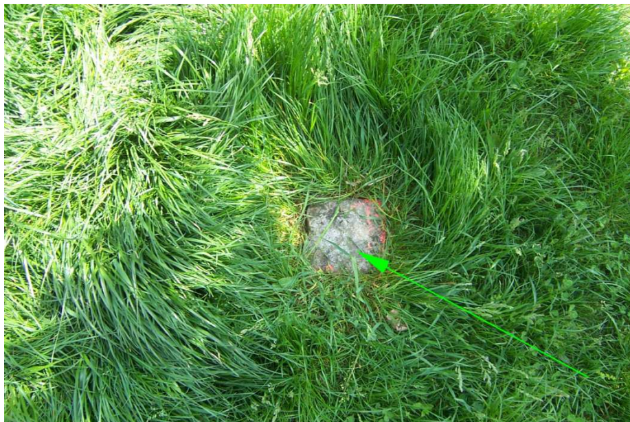
Obr. č. 18 – Stabilizace PPBP – kámen s vytesaným křížkem
