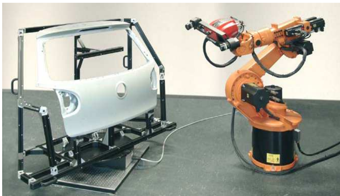
Obr. 1.4 Systém ATOS umístěný na robotnickém rameni 28 .
