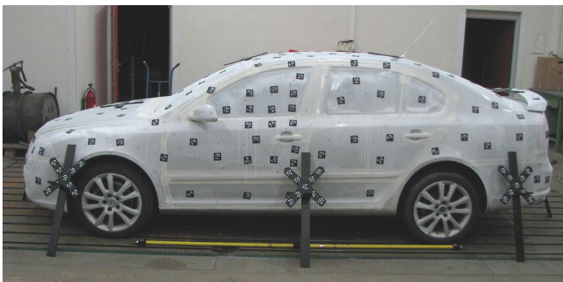
Obr. 3.11 Automobil připravený na skenování systémem TRITOP.
