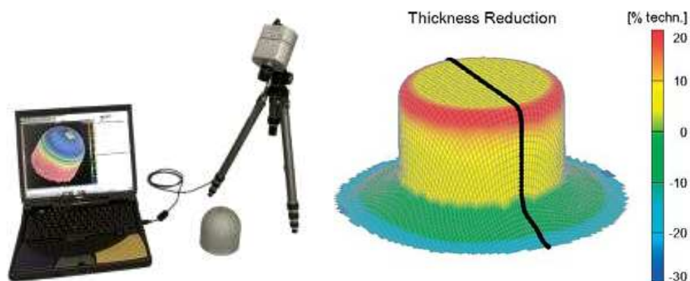
Obr.1.6 Sestava systému Argus 10 a výstup měření v podobě barevné mapy změny tloušťky materiálu 28 .
