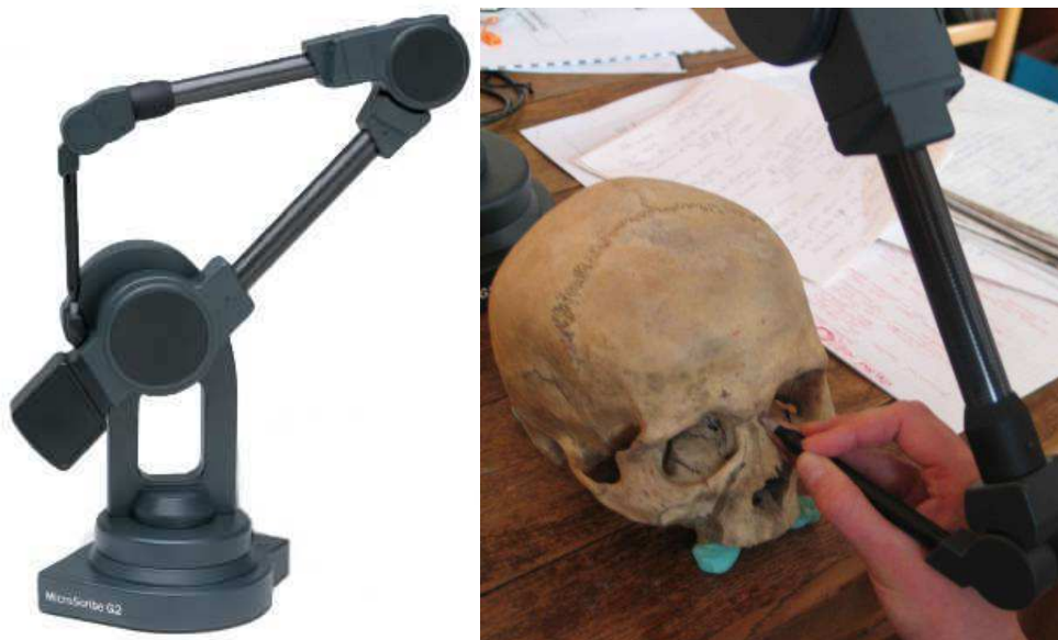
Obr.1.11 Dotykový skener Microscribe G2X a jeho využití v antropologii 25 .
