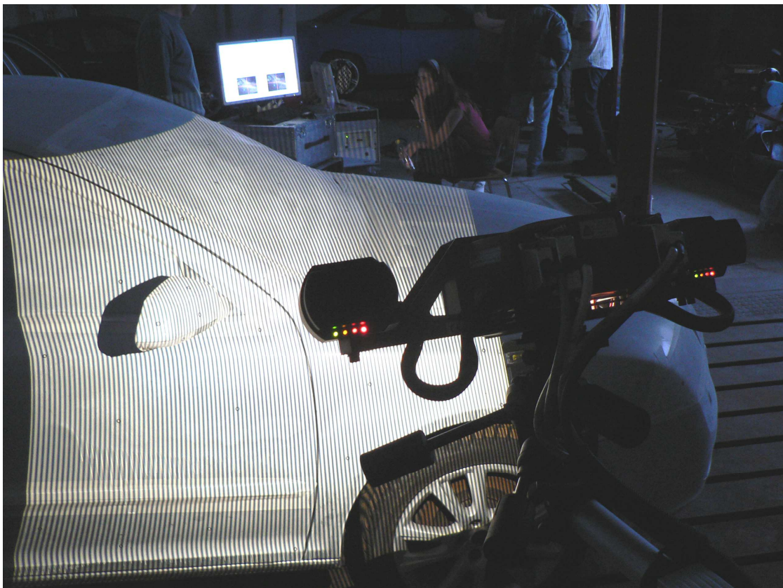
Obr. 3.9 Proces vlastního měření systémem ATOS
