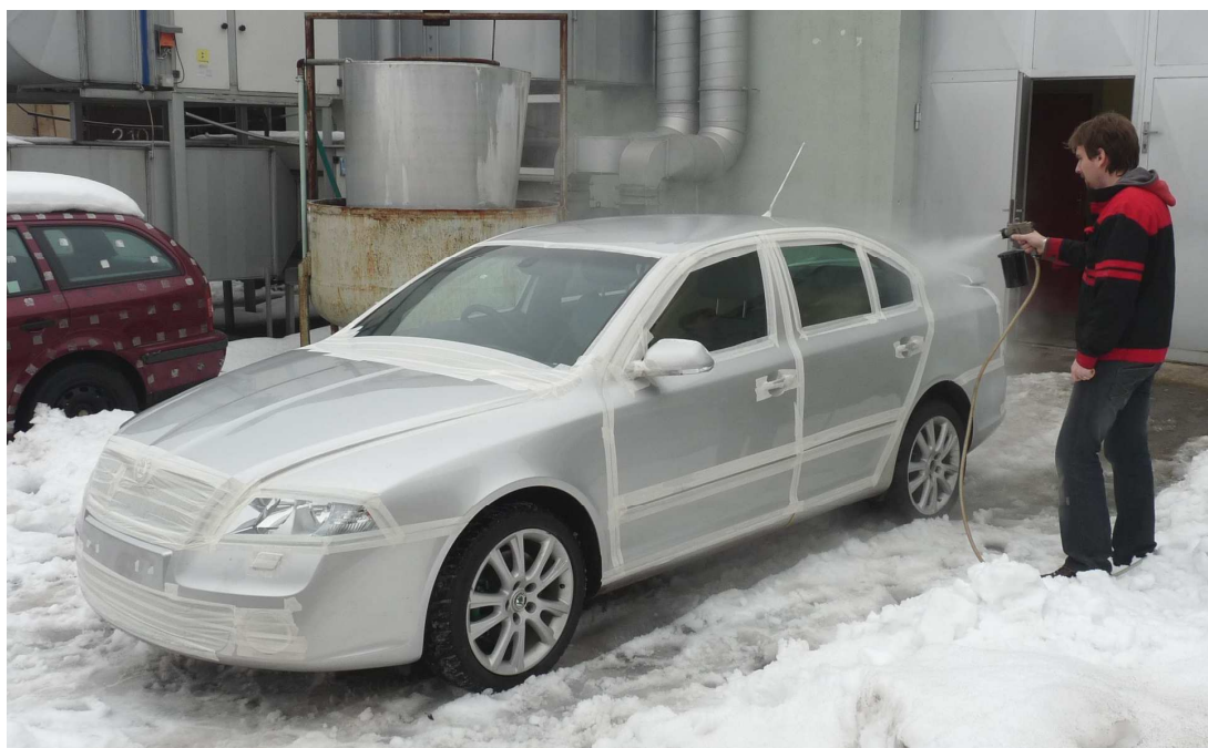
Obr. 3.2 Nanášení 1. vrstvy vývojky.
