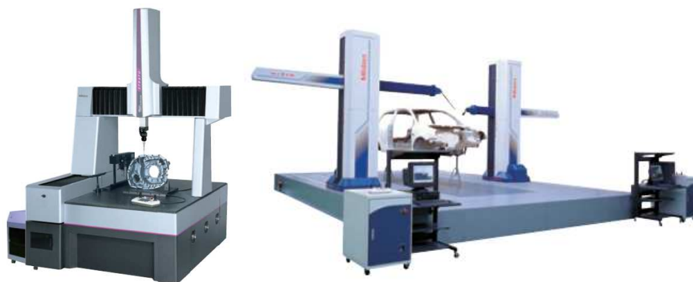
Obr.1.13 Souř. měřicí stroje CMM Mitutoyo Euro C-STRATO a CARBstrato 26 .
