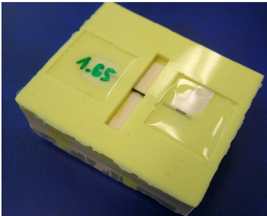
Obr. 9: Kaučuková forma ze tří typů Lukoprenu pro přípravu zkušebních těles s vrubem o hloubce 1,65 mm
