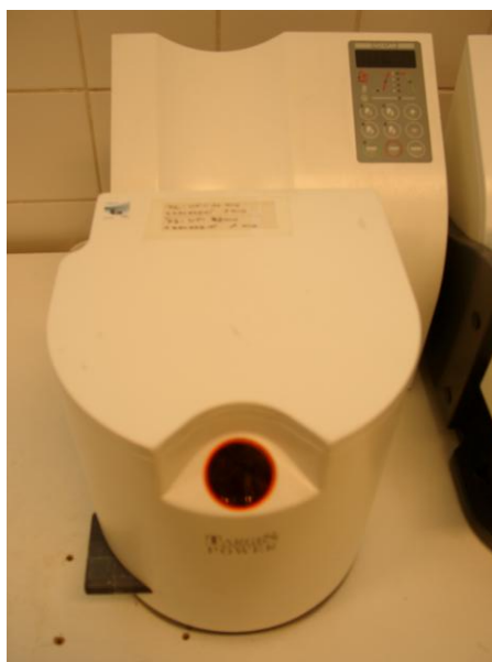
Obr. 10: Polymerační komora pro vytvrzování světlem Targis Power (Ivoclar)
