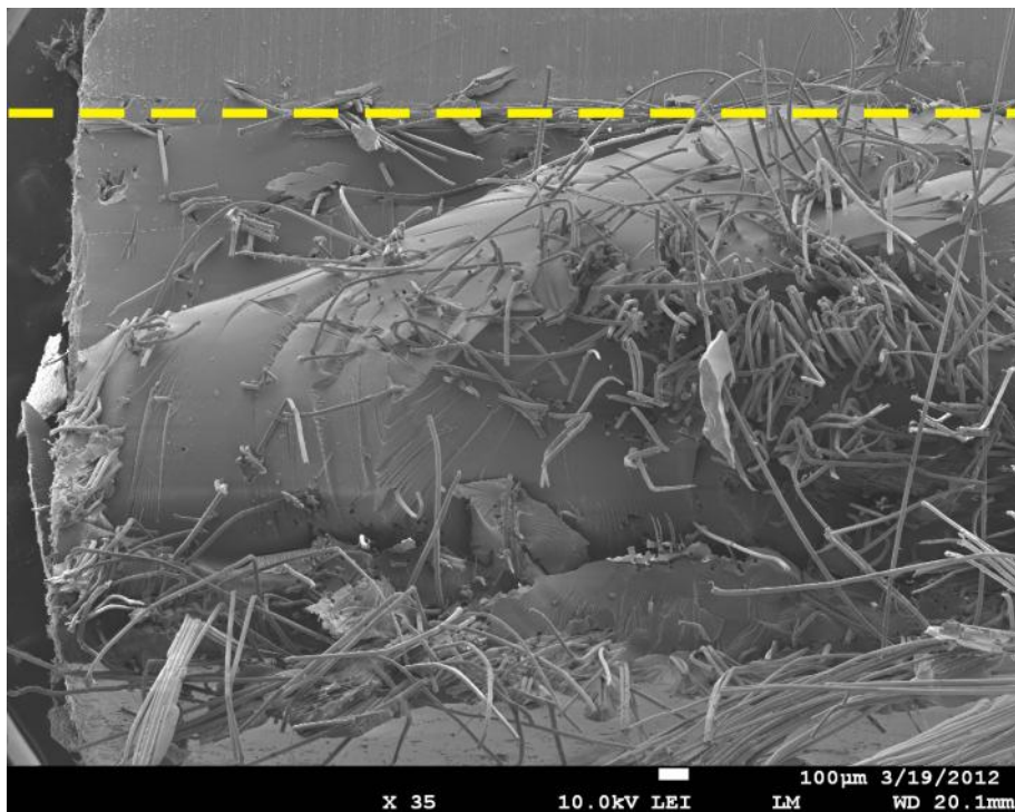
Obr. 30: Materiál typu M.F1 s 4 obj. % PVAL vláken (zvětšení 53x)
