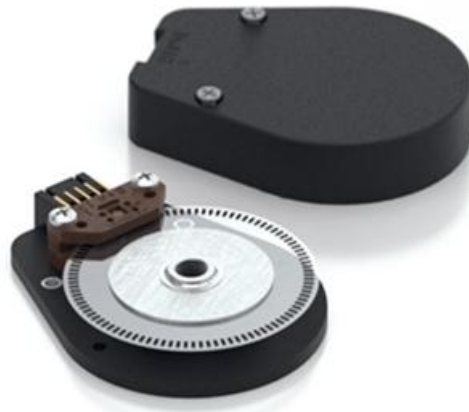
Obr. 3.3.5.2: Tienidlový rotačný enkodér (disk je vyrobený zo skla a na skle je v pravidelných rozstupoch nanosená čierna optická stopa, ktorá striedavo zatieňuje odkrýva optozávoru. To pri otáčavom pohybe generuje požadovaný signál) [20]
