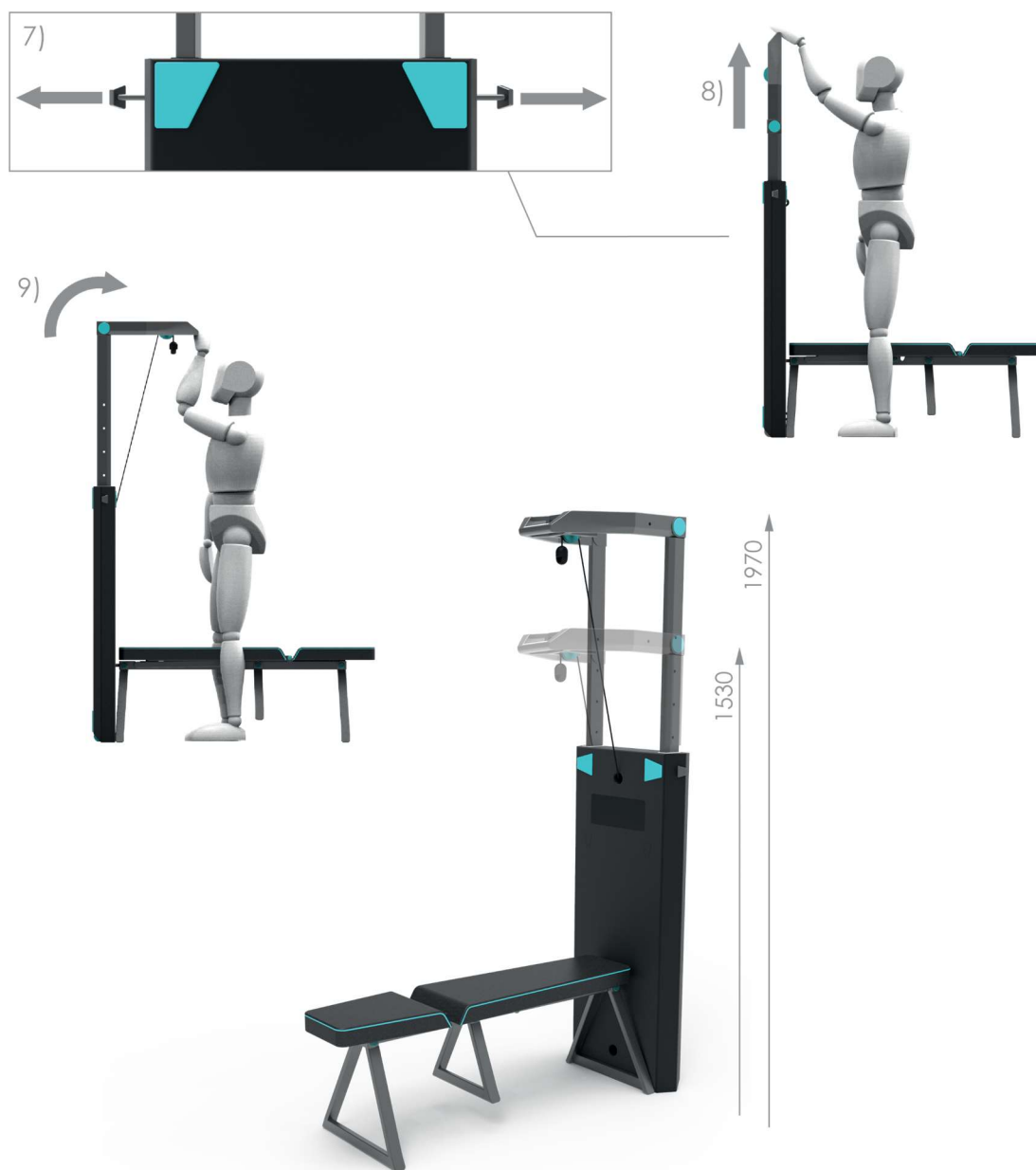
obr. 6-29 Transformace sestavy pro vertikální tah, druhá část
