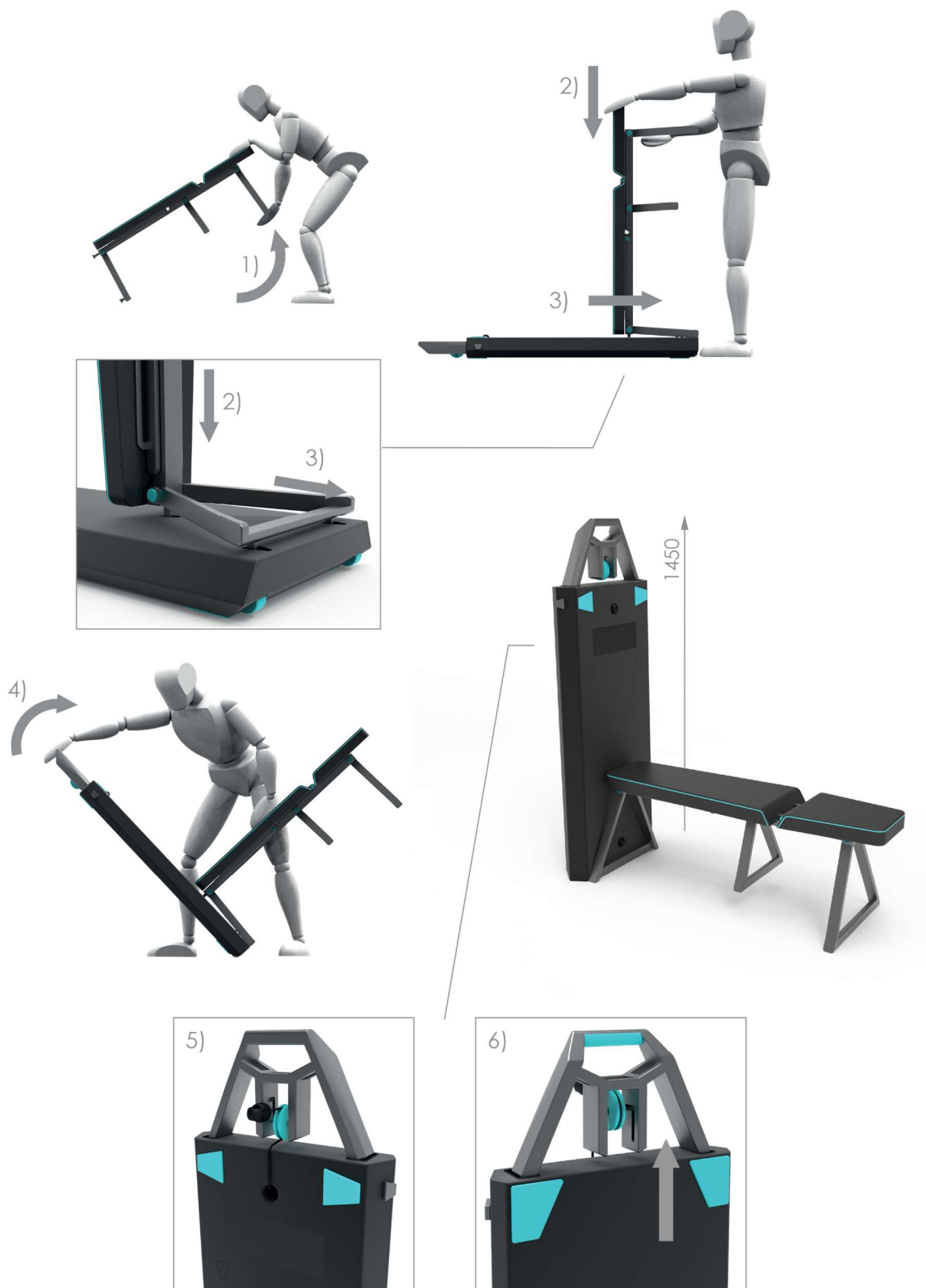
obr. 6-28 Transformace sestavy pro vertikální tah, první část
