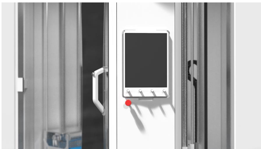
Obr. 6 - 27 Detail - madlo, ovládací panel a nouzové tlačítko
