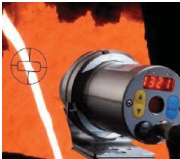
Obr. 16: Měření teploty tekutého kovu během lití pomocí pyrometru [14].
