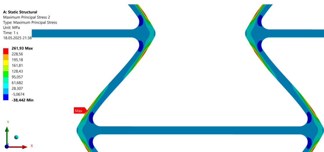
Obr. 7.26: Průběh prvního hlavního napětí na struktuře při tvrdém zatěžování v tlaku.
