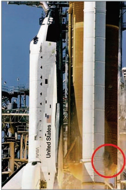
Obr. 32 Challenger – start a zaznamenaný kouř u pravého pomocného motoru,[25]
