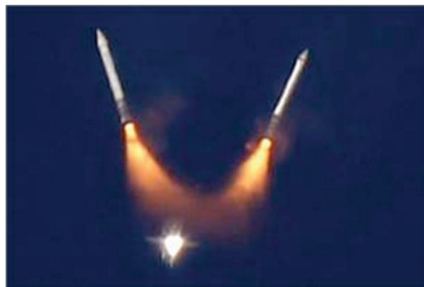
Obr. 23 Oddělení pomocných motorů od orbitální části raketoplánu a externí nádrže, [6]
