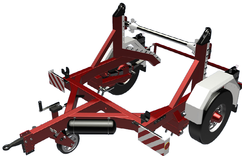
Obr. 71 – Kabelový vlek Variant 350 s navrženou konstrukční úpravou
