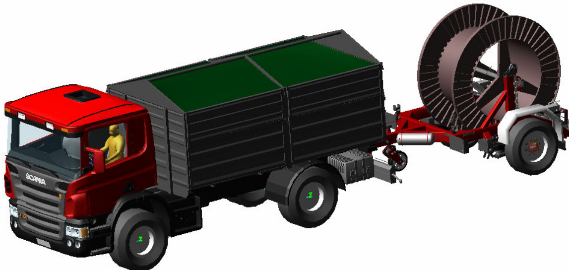
Obr. 12 – Sestava kabelového vleku a Scanie P420
