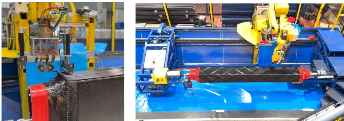
Obr. 4 Navíjení robotickým manipulatorem, řešení firmy Compo Tech PLUS, spol. s r.o., převzato z [24]
