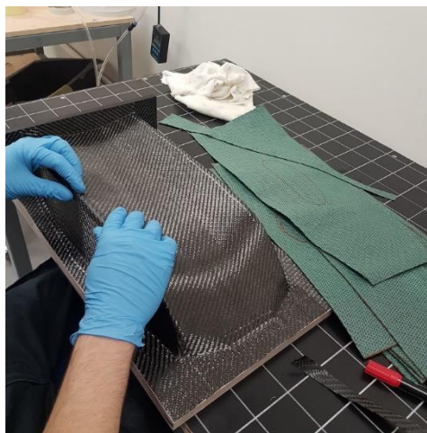
Obr. 3 Kladení prepregů na formu, převzato z [20]
