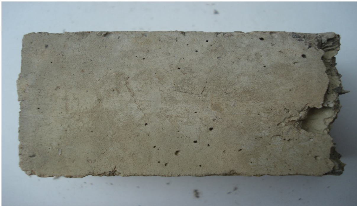
Obrázek 23 – Fragment zkušebního tělesa receptury AŽ05S s obsahem kameniva popílkového agloporitu a amfibolitu v poměru 1:1 a dávkou siliky 3 % z hmotnosti cementu po zatížení teplotou 1000 °C
