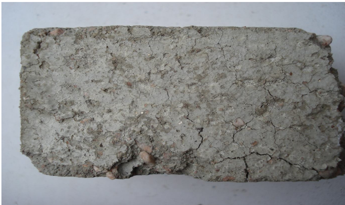
Obrázek 22 – Fragment zkušebního tělesa při zkoušení vlivu kameniva živcového písku při teplotním zatížení 1000 °C
