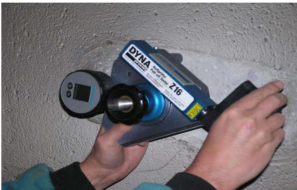
Obrázek 20 - Ukázka odtrhové zkoušky [39]
