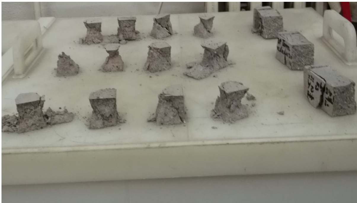
Obrázek 21- Vliv rostoucí teploty na poškození zkušebních těles v tlaku za použití polyolefinových vláken (názorná ukázka poškození malty po vyjmutí z lisu) zprava 20; 200; 300; 400; 500 ^{\circ}\text{C}
