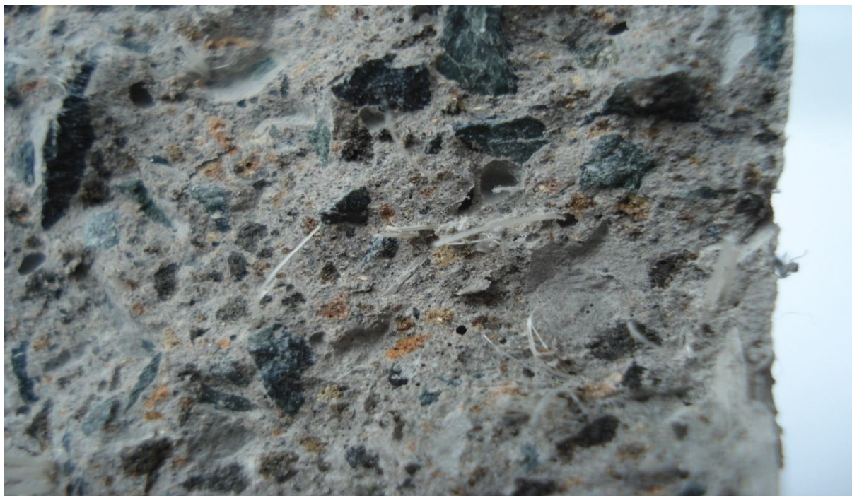
Obrázek 24 – Lomová struktura receptury AŽ03S nezatížené bez teplotní zátěže
