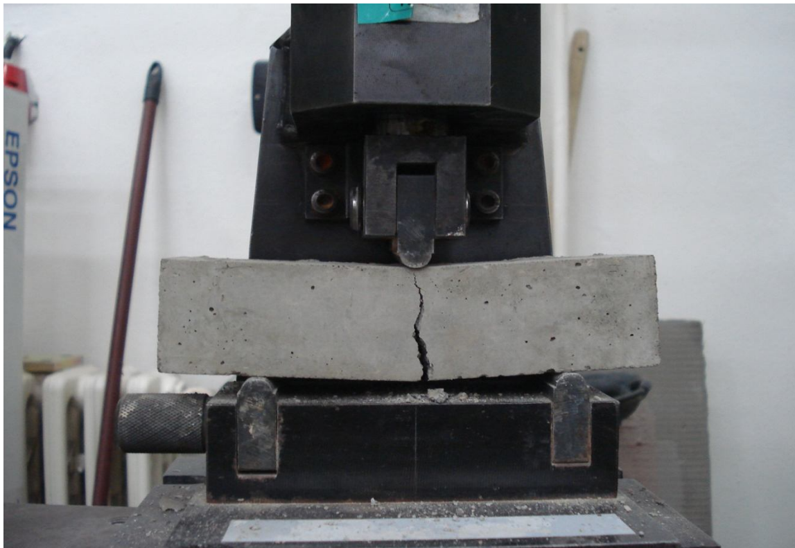
Obrázek 16- Pevnost v tahu ohybem zkušebního tělesa (160x40x40 mm)
