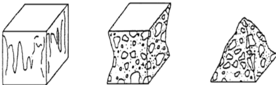
Obrázek 17- Vyhovující způsoby porušení zkušebních těles
