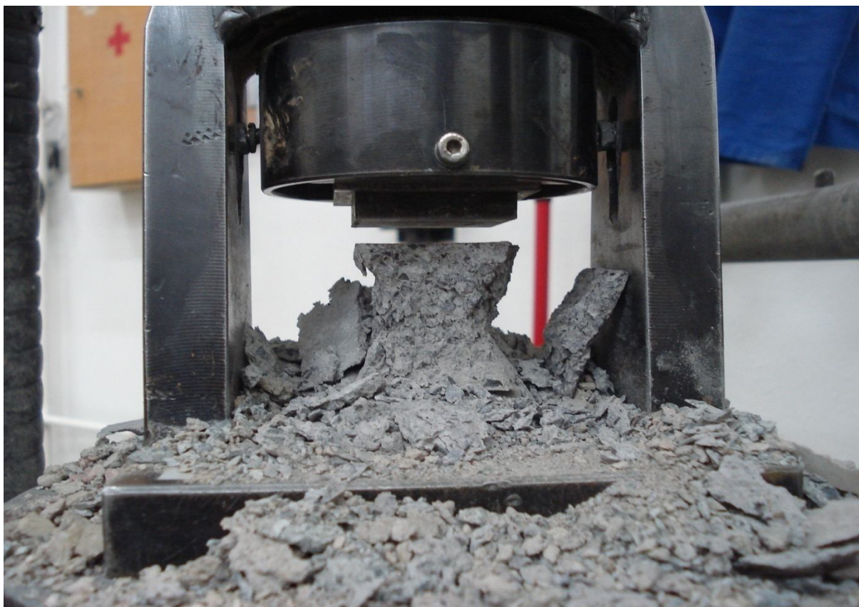
Obrázek 18 – Ukázka destruktivní zkoušky porušení pevnosti zkušebního tělesa tlakem
