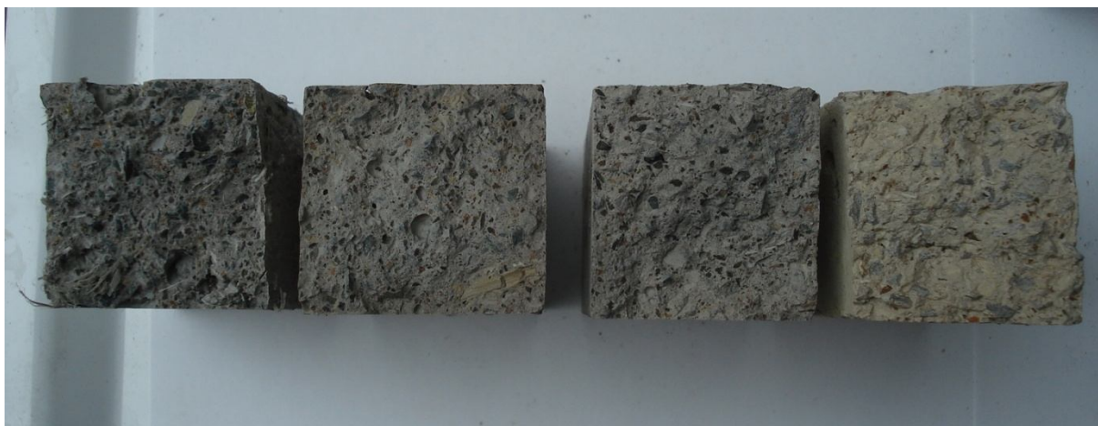
Obrázek 25 – Barevné rozdíly pozorovatelné u receptury na lomových plochách AŽ03S v závislosti na teplotě, zleva 20, 400, 600, 1000 °C
