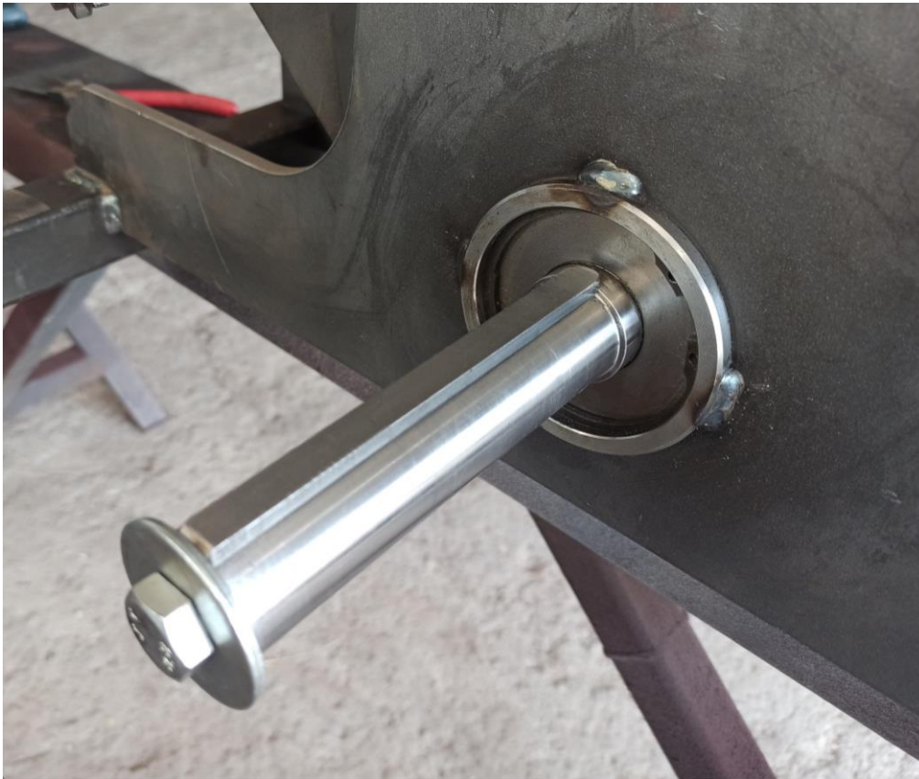
Obr. 14 Hnací hřídel po montáži.
