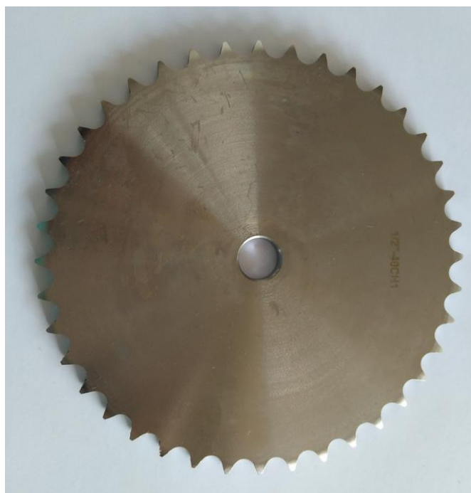
Obr. 29 Zakoupené řetězové kolo bez náboje.
