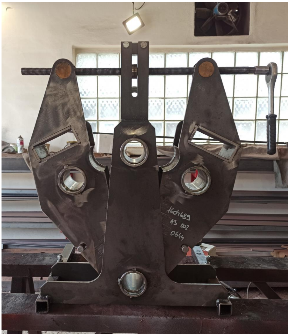
Obr. 13 Plechové výpalky tvořící konstrukci stroje.
