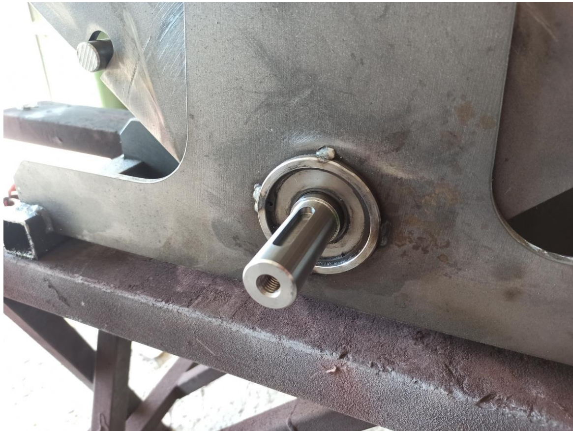
Obr. 25 Výstupní hřídel pro ruční pohon.
