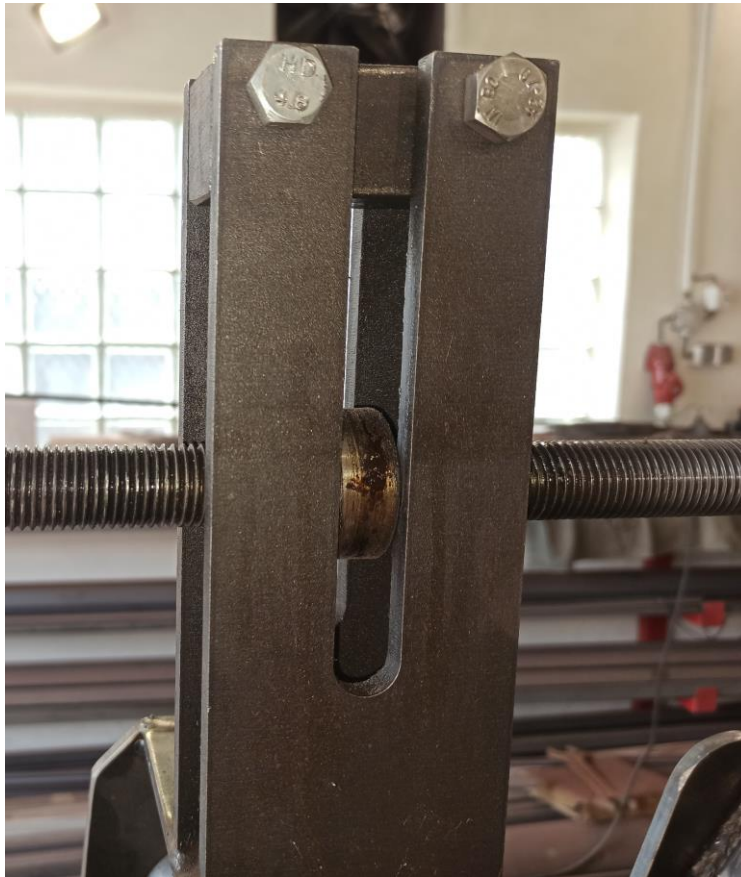
Obr. 12 Detail uchycení středu šroubu M22xM22LH.
