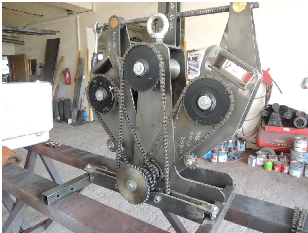
Obr. 28 Rozvodový mechanismus s kolem pro napojení elektromotoru.
