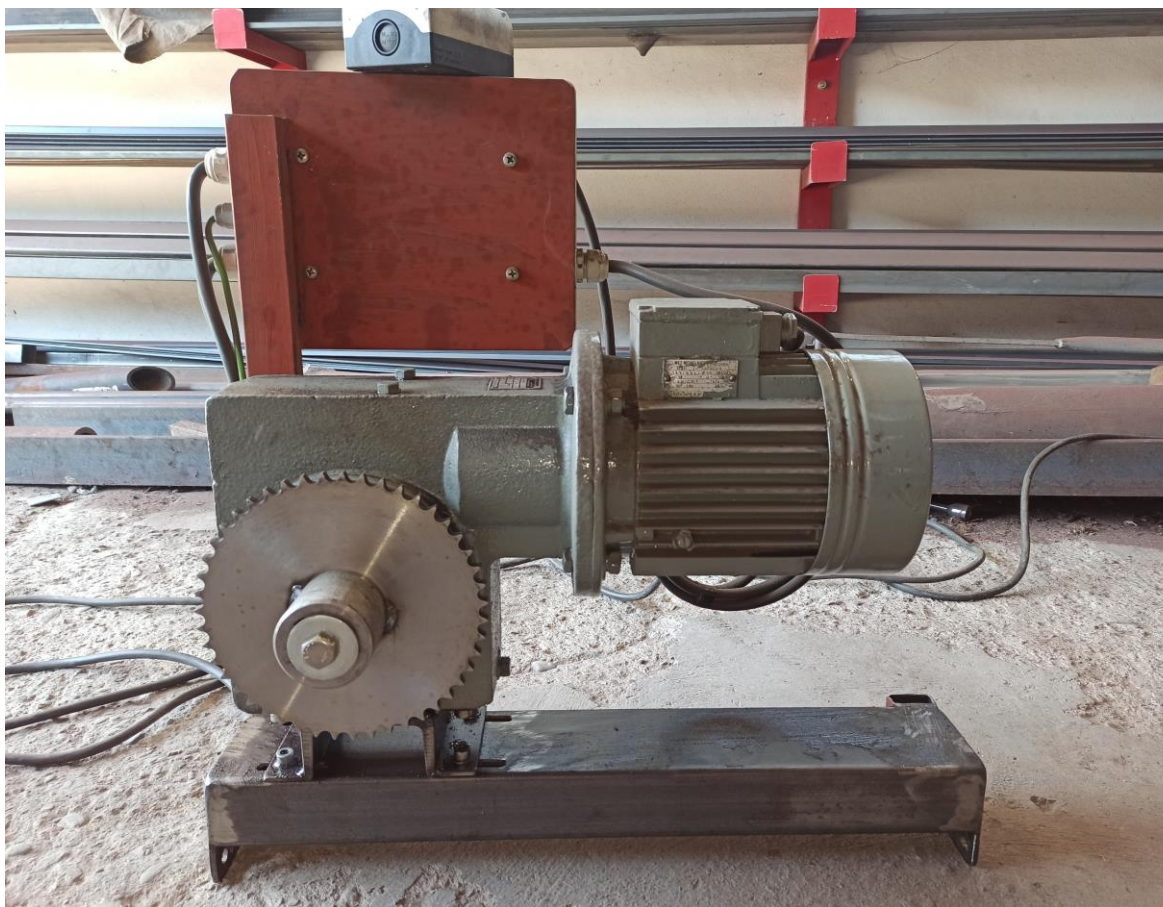
Obr. 24 Elektromotor s převodovkou na snímatelném uchycení.
