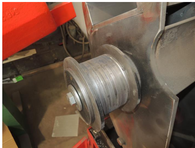
Obr. 21 Tvarový válec z plechových výpalků.
