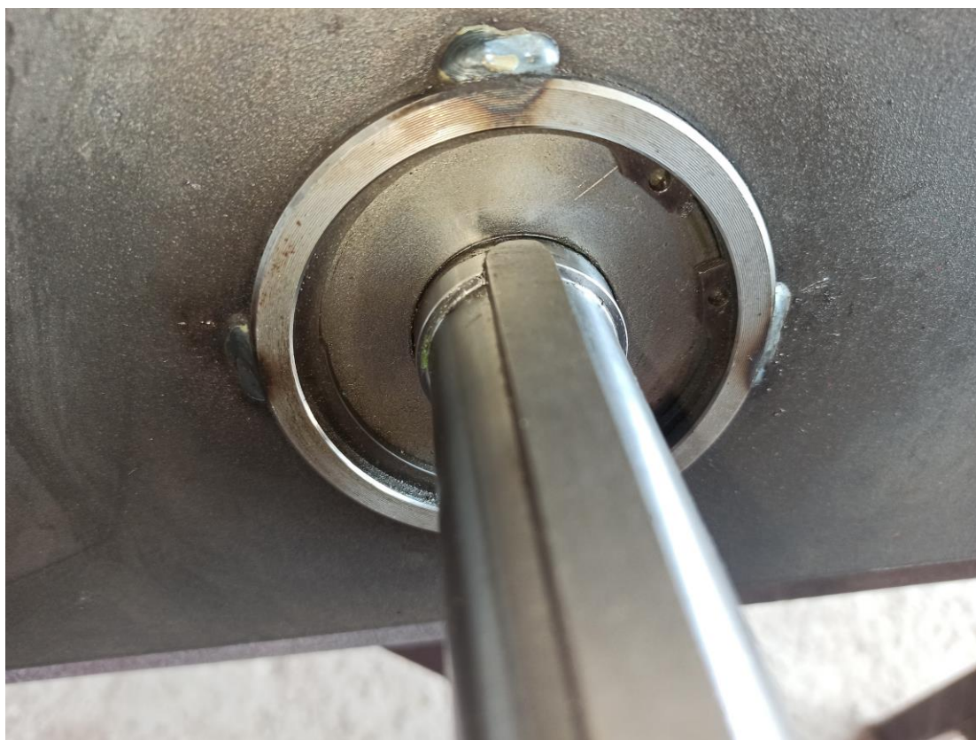
Obr. 16 Detail krytky ložiska s pojistným kroužkem.
