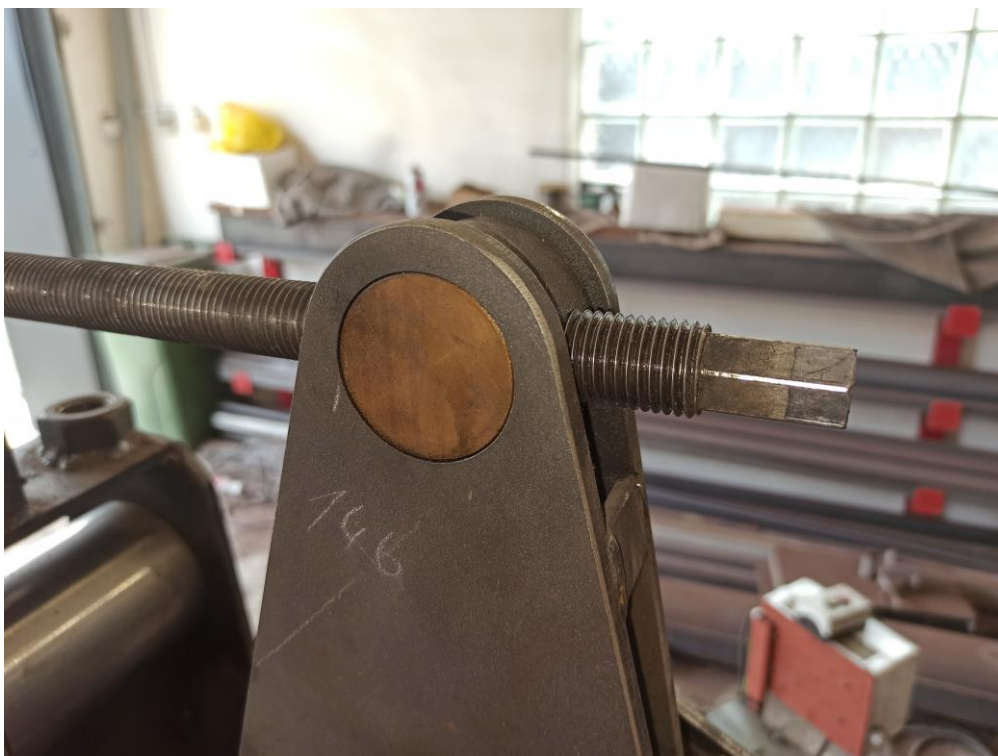
Obr. 11 Detail šroubu M22xM22LH s maticí.
