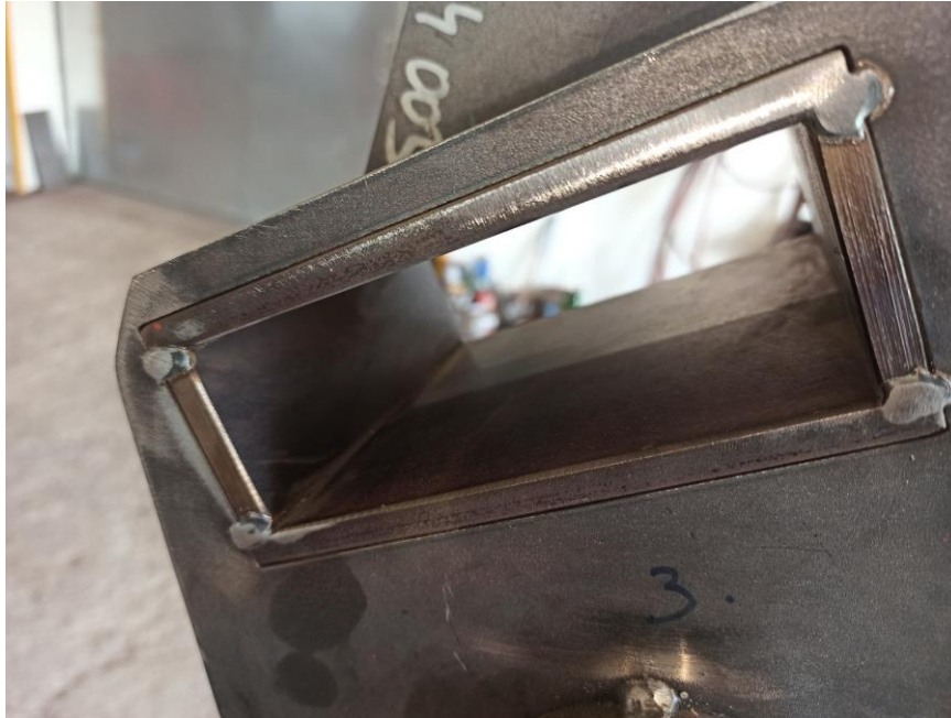
Obr. 17 Detail uložení pro mechanismus na výrobu spirály.
