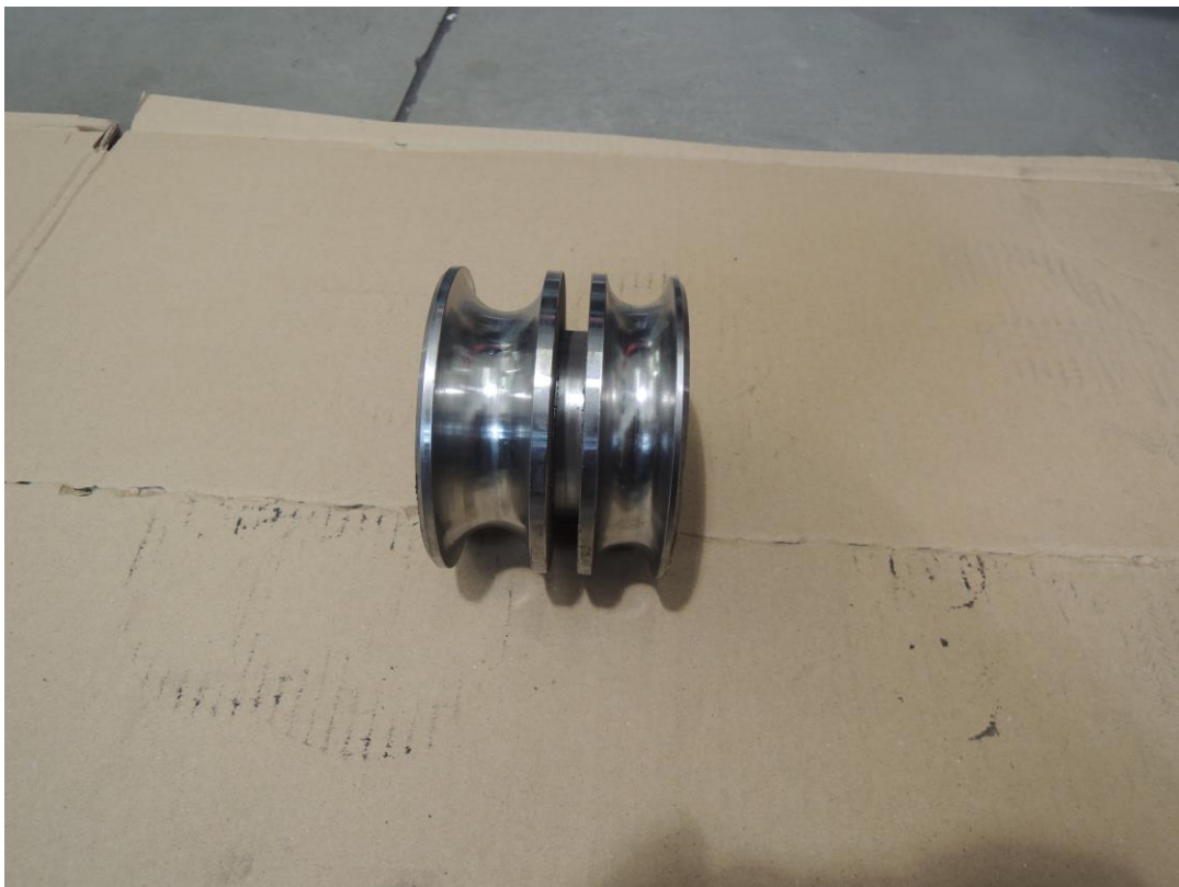
Obr. 23 Sdružený tvarový válec.
