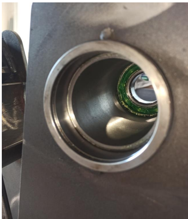
Obr. 15 Detail náboje s ložiskem.
