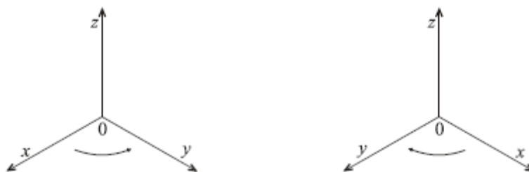
Obr.2 Pravotočivá a ľavotočivá súradnicová sústava [1].
