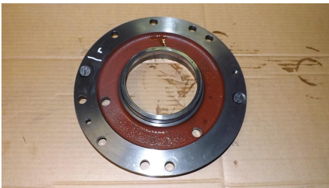
Obr.14 Levá příruba (15.154.003) s montážními šrouby a klecí ložiska
