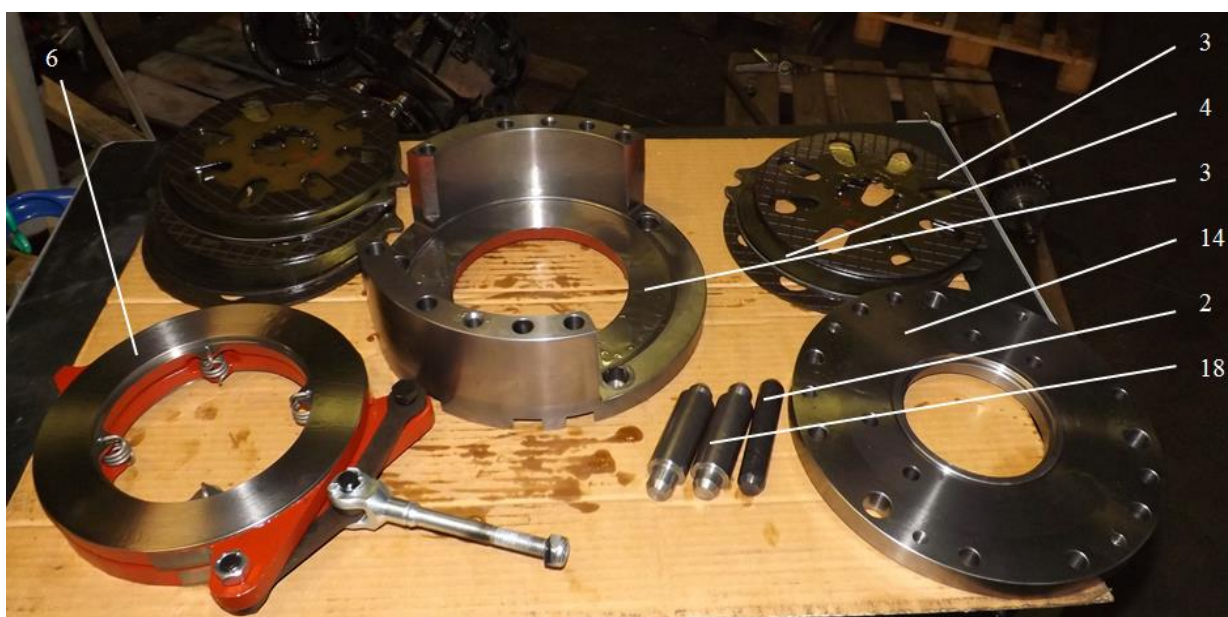
Obr.12 Součásti původního brzdového koše na levé straně rozvodovky Popis odpovídá popisu obr. 10, 18-brzdový čep (96.227.003)
