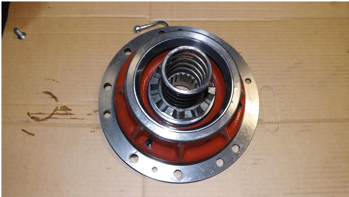
Obr.18 Pravá příruba s pístem, ložiskem, objímkou uzávěrky a pružinou [vlastní foto]
