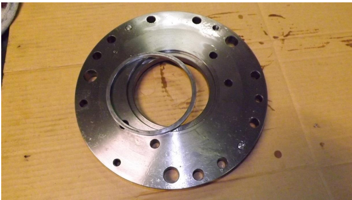
Obr.13 Levý základní disk (16.227.006) s vmezovacím kroužkem (15.154.005)
