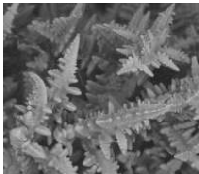
Obr. 28 Fotografie dendritické struktury kovu rastrovacím elektronovým mikroskopem, [21]
