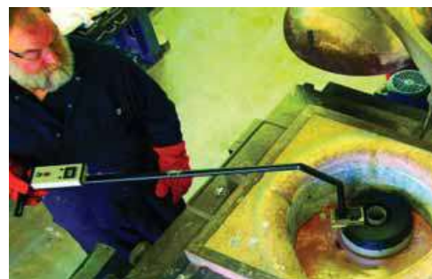
Obr. 26 Příklad přístroje na měření čistoty taveniny ALSPEK* MQ a foto z probíhajícího měření, [20]
