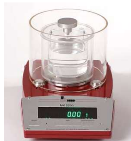
Obr. 21 Měřicí váhy k měření DI, [17]
