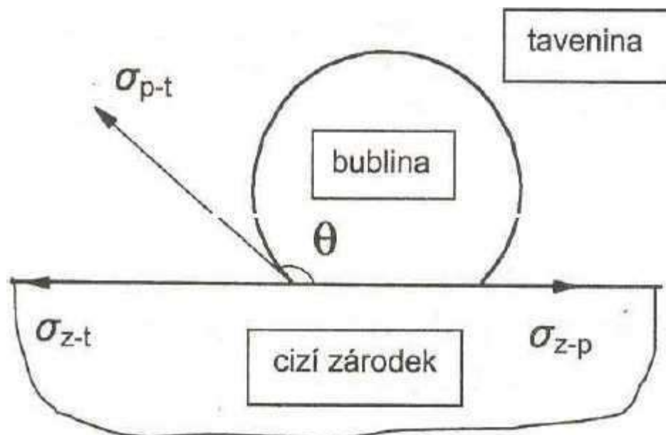
Obr. 15 Schéma heterogenní nukleace bubliny na cizím zárodku, [3]
