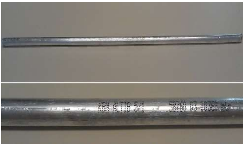
Obr. 30 Očkovadlo AlTi5B1 použité u zkoušky.
