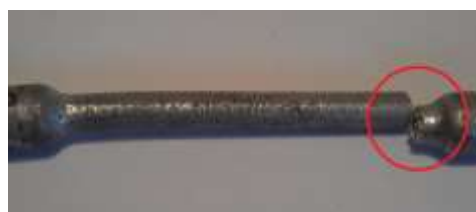
Obr. 52 Špatně přetržená trhací tyč, odlitove firmě Fimes a.s.
