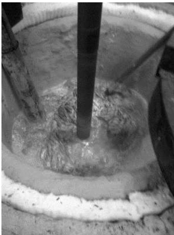
Obr. 18 Pohled do právéodplyňovaného kovu v pánvi, [14]
