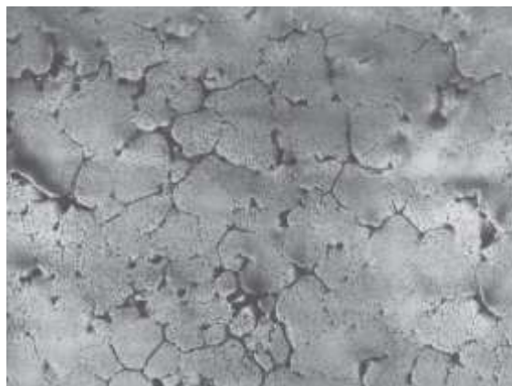
Obr. 6 Slitina AlZn6MgCu, na výbrusu v litém stavu patrná mezidendritická porezita, [7]
