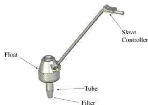
Obr. 26 Příklad přístroje na měření čistoty taveniny ALSPEK* MQ a foto z probíhajícího měření, [20]
