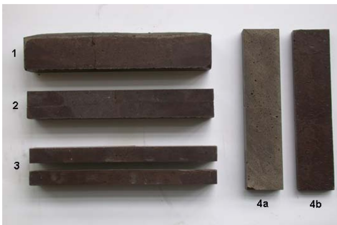
Obrázek č. 26: Objekt 1 je zkušební těleso po vyjmutí z formy, objekt 2 je po odřezání přerostu a objekt 3 je rozpuřený objekt 2 tj. zkušební tělíska pro měření mechanických vlastností. Objekt 4a plocha řezu ve srovnání s 4b, což je spodní plocha původního tělesa.
