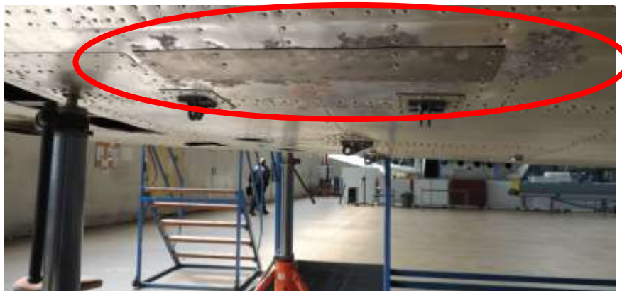
Obrázek 5.3: Koroze spodní části trupu
