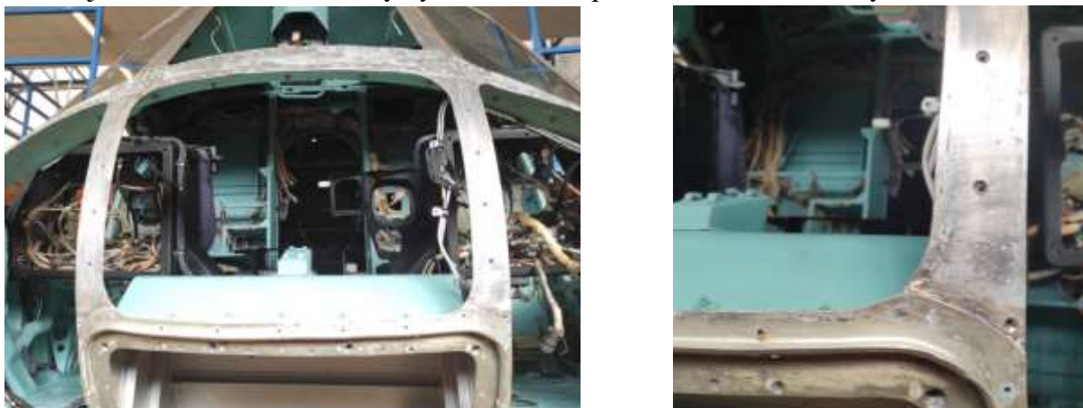
Obrázek 5.8: Koroze rámu kabiny
