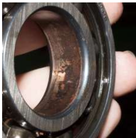
Obrázek 2.3: Vibrační koroze ložiska
