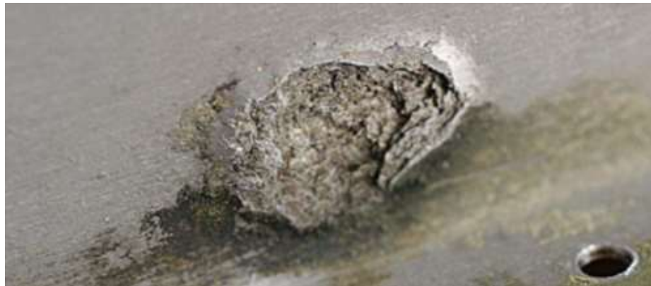
Obrázek 3.4: Mezikrystalová koroze hliníku
