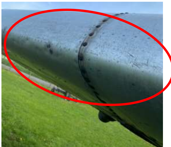
Obrázek 5.16: Poškození náběžné hrany křídla
