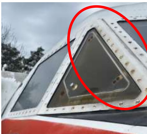
Obrázek 5.25: Koroze v místě šroubů
