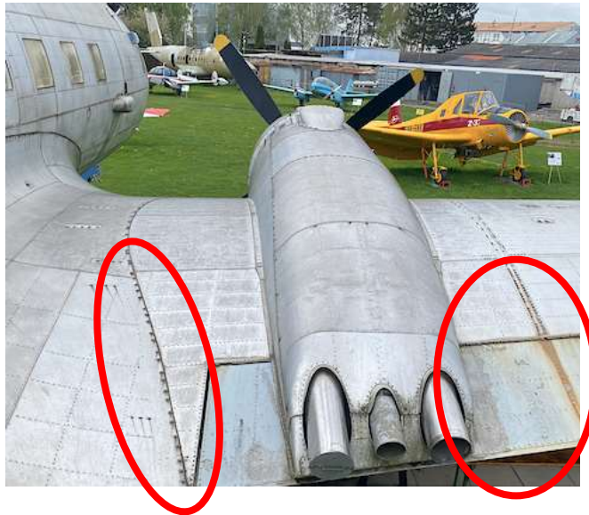
Obrázek 5.18: Koroze na povrchu křídla
