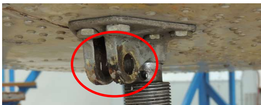
Obrázek 5.10: Koroze podvozkové konzole
