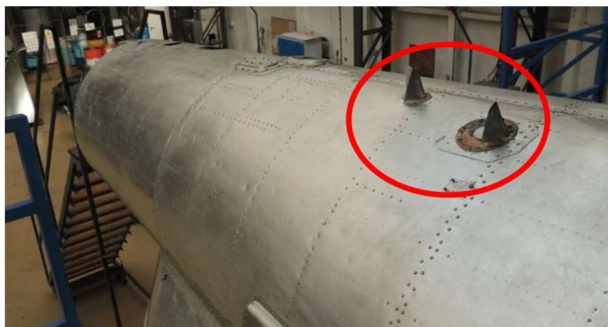
Obrázek 5.9: Koroze v místě uchycení antén
