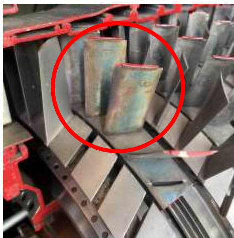
Obrázek 5.22: Koroze kompresorových lopatek
