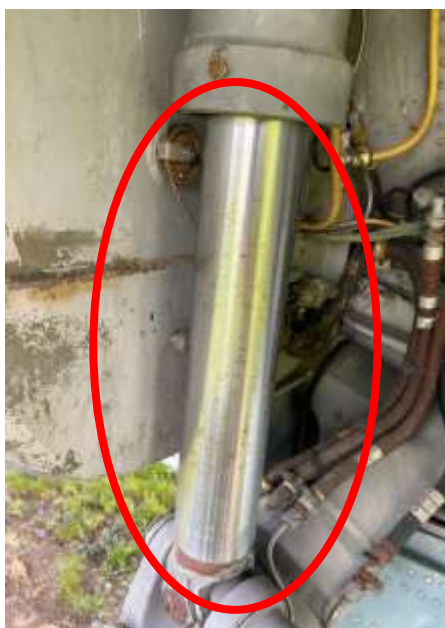
Obrázek 5.13: Koroze tlumiče podvozku
