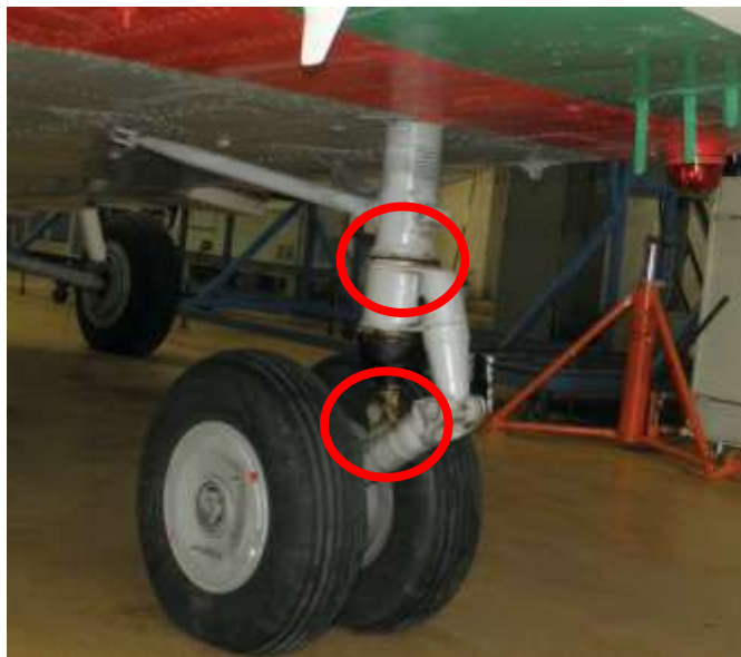
Obrázek 5.14: Koroze předního podvozku Mi-8
