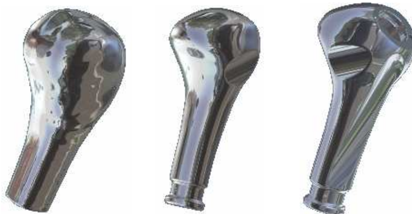
Obr. 3.29 Porovnanie prvotného výstupu so skeneru a hotového prototypu.
