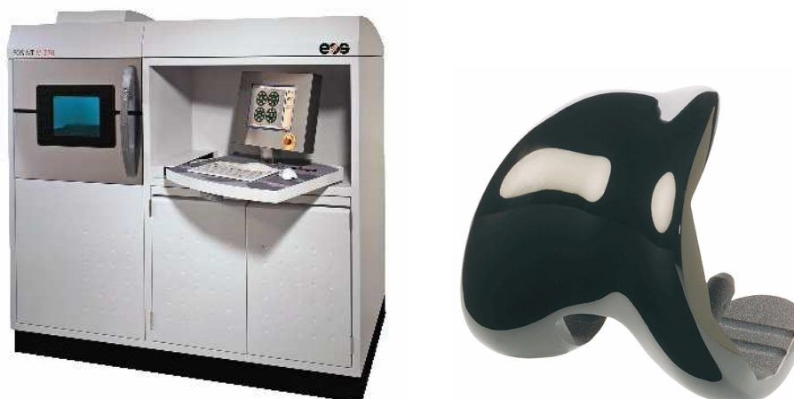
Obr. 4.38 a) zariadenie DMLS EOSINT M270, b) výrobok – kolenný implantát 6 .
