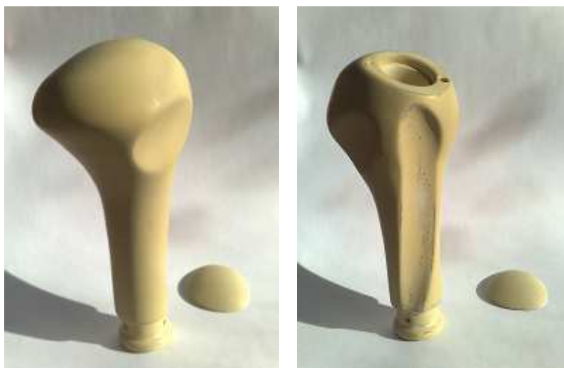
Obr. 4.55 Plničom ošetrovaný vyhladený model hlavice a vrcholíka.
