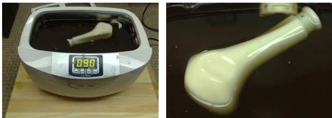
Obr. 4.53 Takmer ukončený proces odstraňovania podpory v ultrazvukovej čističke.
