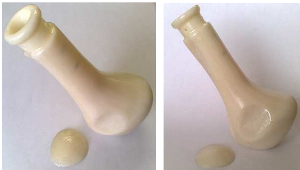
Obr. 4.554 Naleptaný model s výrazne hladším povrchom.
