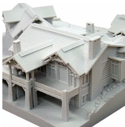
Obr. 4.32 Prototyp vystavaný postupným vytvrdzovaním vrstiev materiálu 11 .
