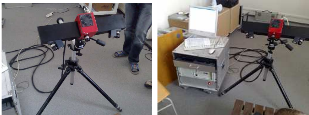
Obr. 3.4 Optické skenovacie zariadenie ATOS.
