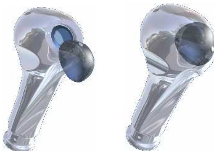
Obr. 3.27 Vyrenderovaný finálny model zostavy hlavice s tlačítkom.
