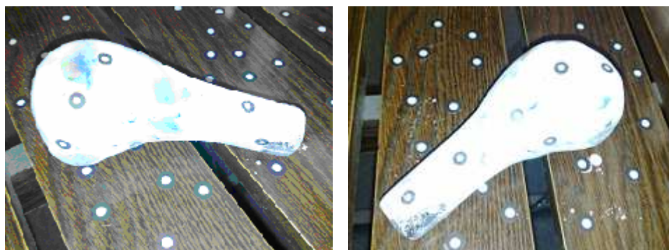
Obr.3.7 Súčasť pripravená na skenovanie – nalepené referenčné značky.
