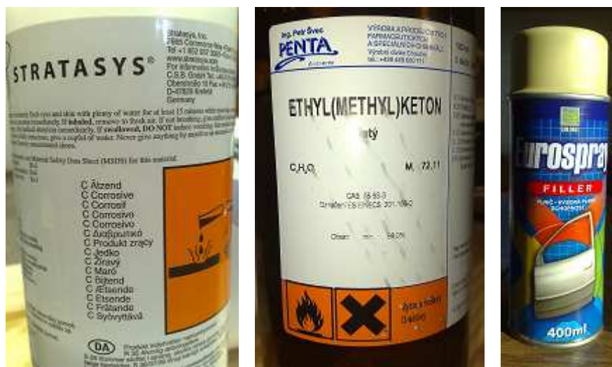
Obr. 4.52 a) chemický prípravok na odstránenie podpory, b) leptadlo povrchu, c) plnič – príprava podkladu pre farebný nános.
