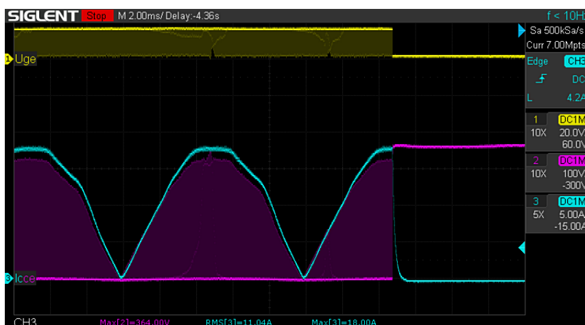
Obr. 6.7: Detail reakce nadproudové ochrany
