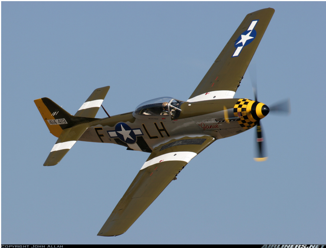
Obrázek 1.2: Letoun P-51 mustang, křídlo lichoběžníkového půdorysu odpovídá předpokladům teorie nosné čáry.[12]
