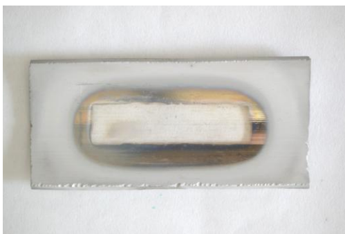
Obrázek 2: Zrcátko – cínová vrstva deponovaná na držák během experimentu.
