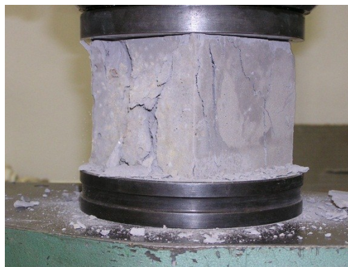
Obrázek 21- Solidifikát z NO B1 po porušení
