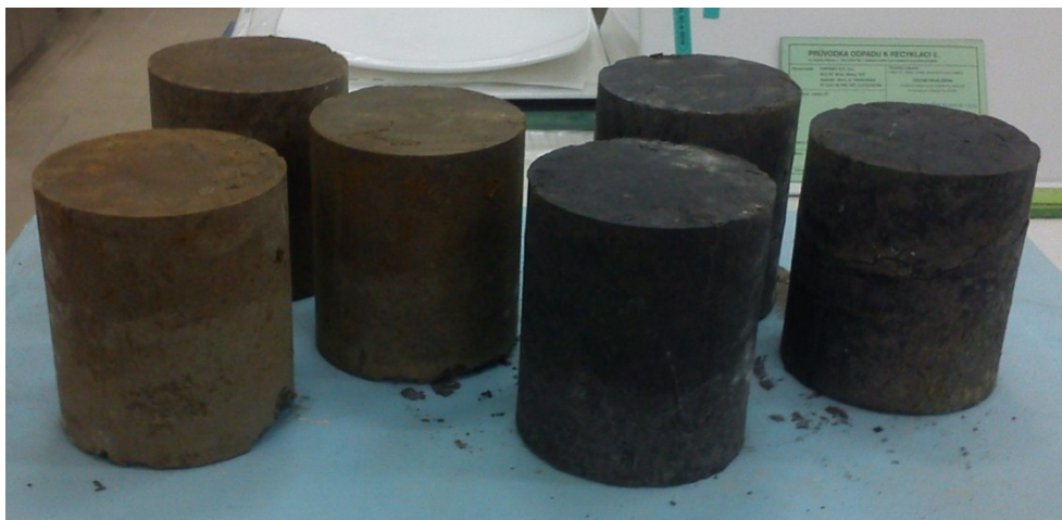
Obrázek 25- Zkušební tělesa pro pevnost v tlaku
