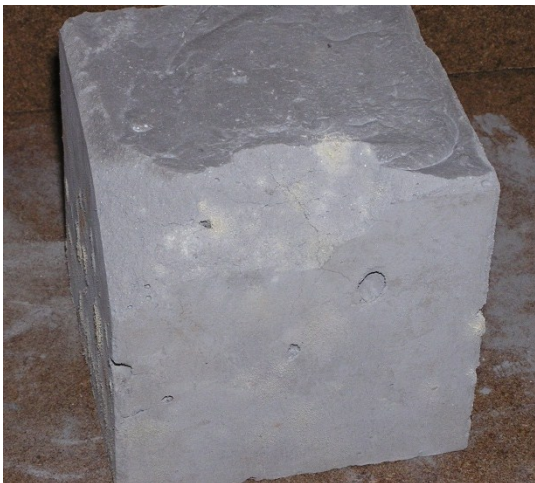
Obrázek 23- Solidifikát z NO 110109 (H) bez přídavku plastifikátoru
