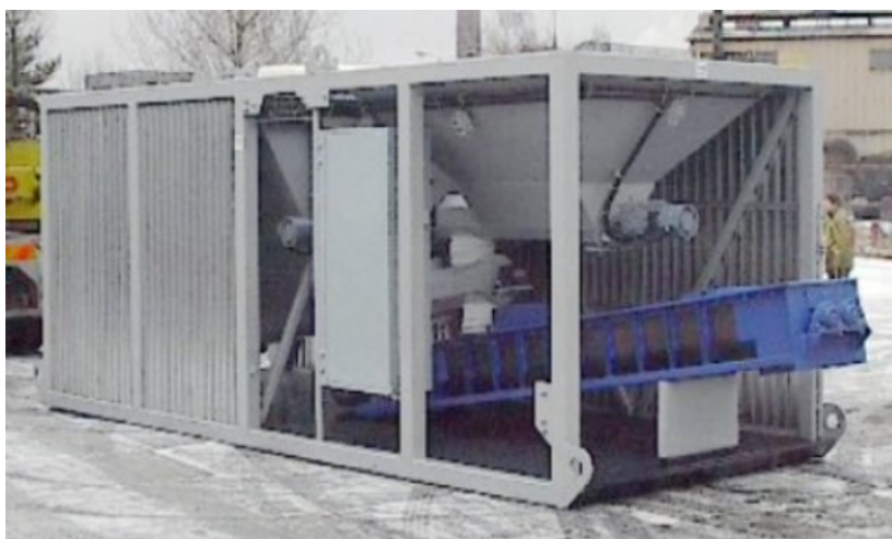
Obrázek 3 - Solidifikační linka MSL-15 [IVM, spol. s.r.o.]
