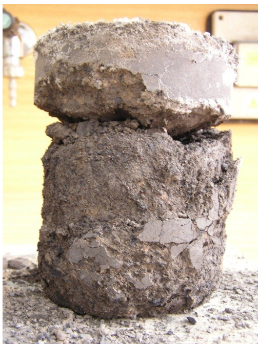
Obrázek 26- Zkušební těleso poškozené mrazem a vodou v celém objemu
