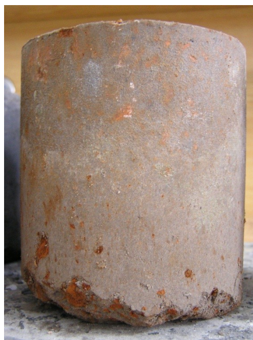
Obrázek 27- Zkušební těleso poškozené pouze ve styku s plstěnou podložkou
